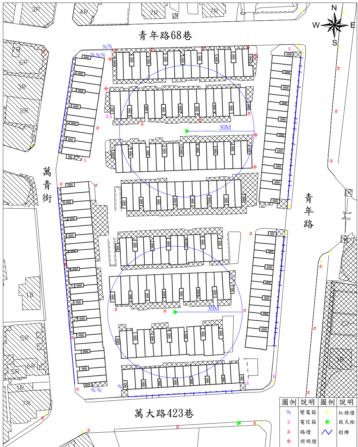
圖 4-8 南機場三號地整宅社區內設施物調查圖
