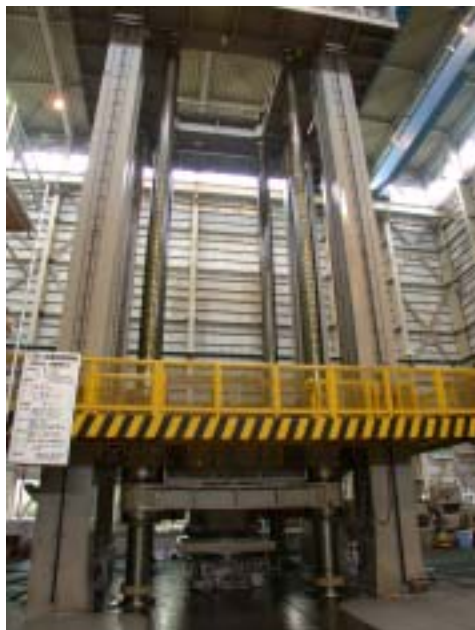
圖 2.17 日本 Nihon University 3000 噸萬能材料試驗機
