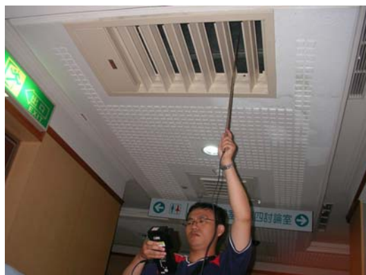
11F 排煙閘門風速量測
