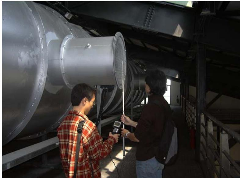
4.擷取數據：與法規規定之排煙風機之風量標準做比對。本次風機校正實驗風量數據測結果，如表 3.3-1 所列。
