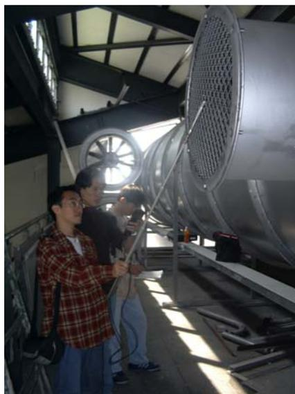
圖 3.3-2 人員於排煙口附近量測風速之情形(2)
