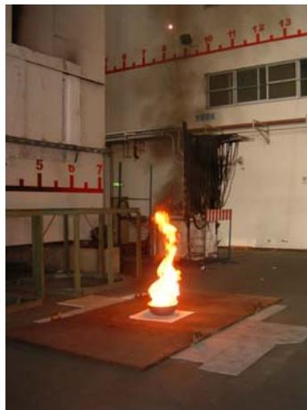
每一油盤之火災規模約為 0.2 MW，因此本校正實驗火源為 0.2、0.4、0.6、0.8、及 1 MW，計從 1 個油盤至 5 個油盤，實驗茲述如下。
