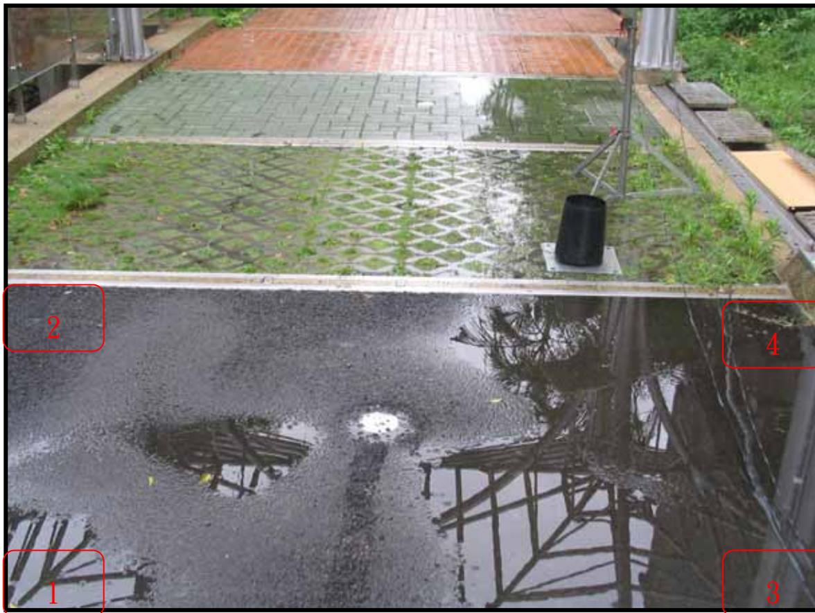
比較剛施工完成之透水係數(表3-14)與現況鋪面透水係數(表3-24)可得知透水係數經一年半後之變化情形(表3-25)，鋪面K值下降;判定其鋪面孔隙有阻塞情形。
