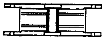
圖 2.3.1.4 積層橡膠與上下端部鋼板之連接
