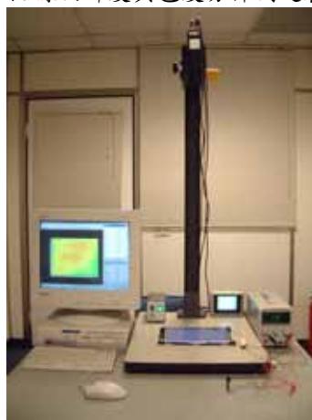
圖 3-18 點線面輝度與色度分佈測定裝置
