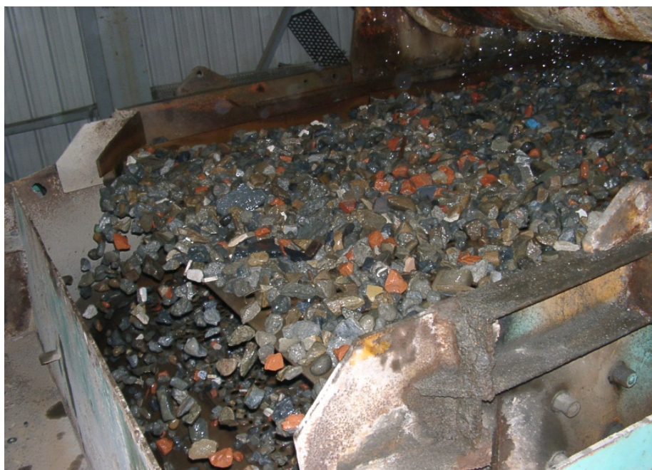
照片 AIII-5 出料之粒料情況
