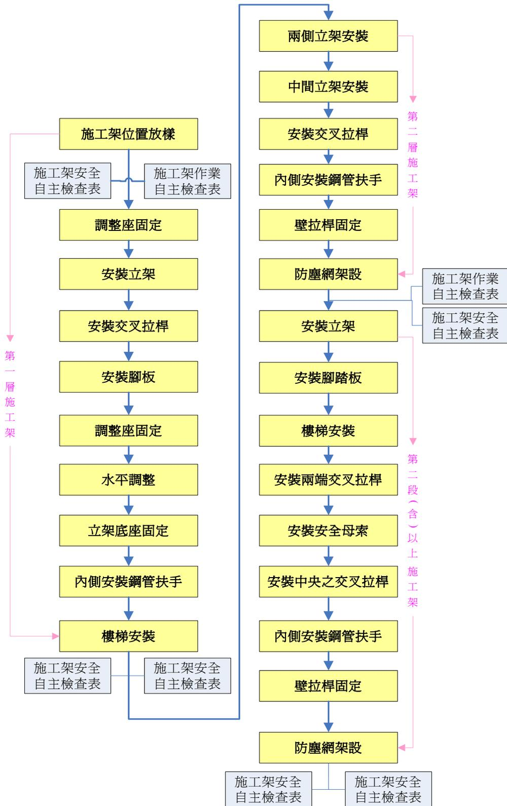
圖 4-1.7 外牆施工架拆解作業流程與品管管控點
