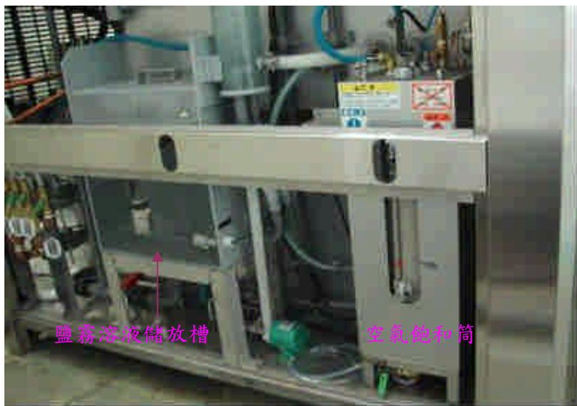
圖 5-3 SUGA CTP96 鹽霧複合耐候試驗機右側照片
