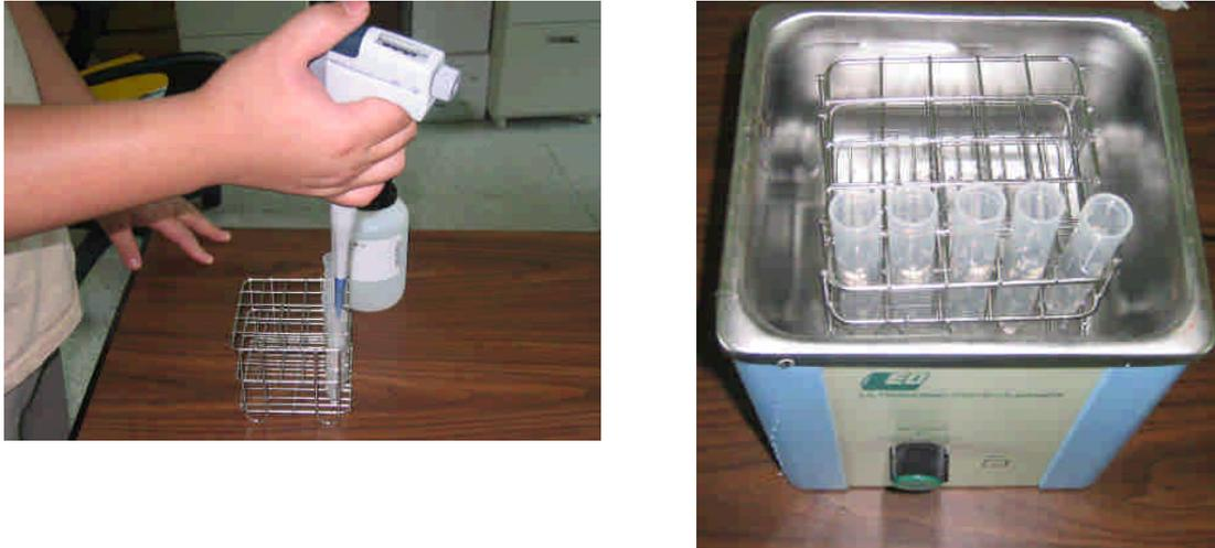
圖 5-20 稀釋標準液配製情形
