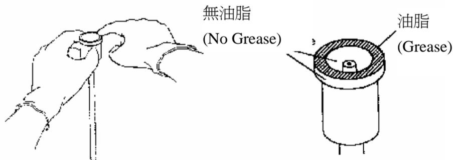
圖 5-14 塗抹真空油脂於樣品試管球部
