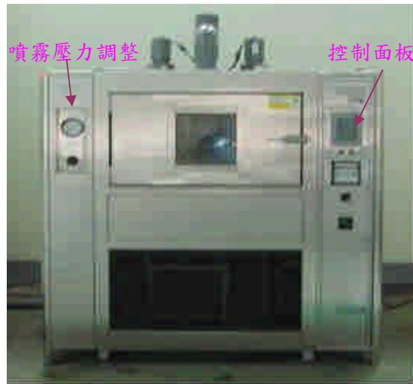
圖 5-1 SUGA CTP96 鹽霧複合耐候試驗機正面照片
