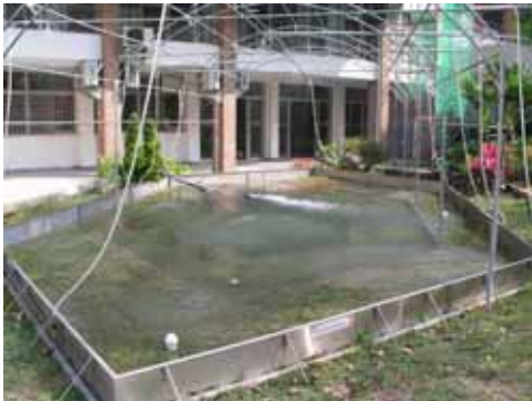
圖 1-7 人工雨場模擬降雨實驗
