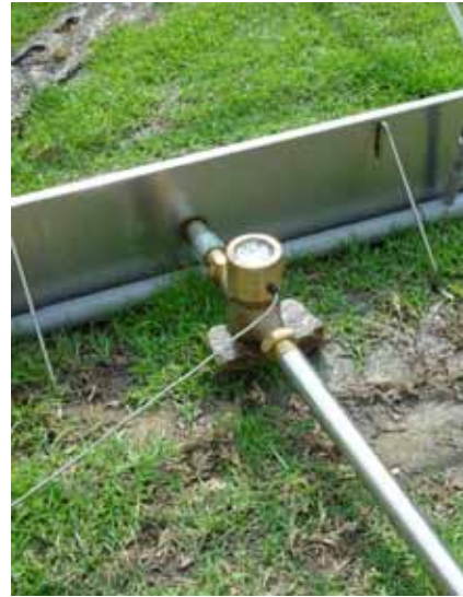
圖 2-11 量計量測溢流之 水量
