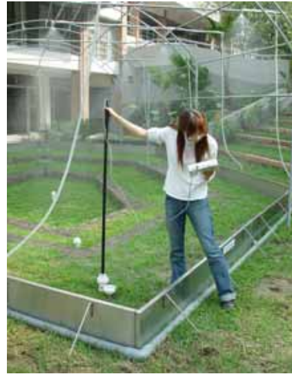
圖 2-8 量測土壤水分
