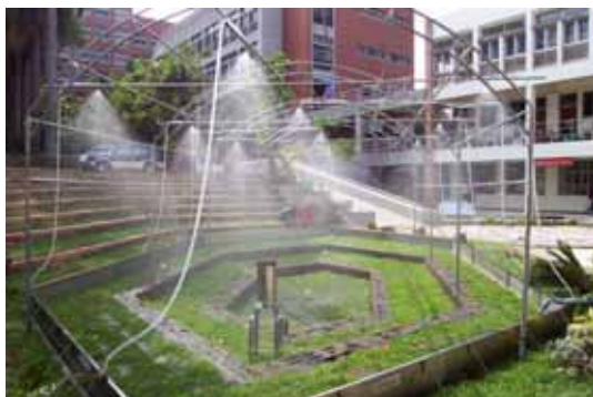
圖 1-7 人工雨場模擬降雨實驗
