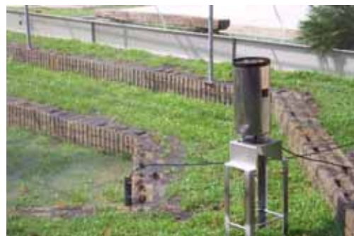
圖 2-10 水位計量測池底 水位變化
