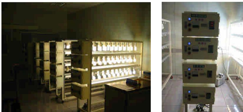
(圖 3-16) 光束維持率/壽命試驗機 (圖片來源：中國電器實驗室)
