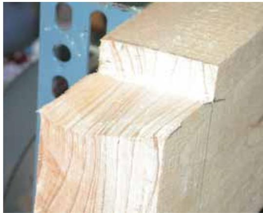
圖 4-8 梁鉤逗部分發生面內剪力破壞
