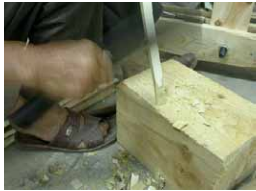
圖 3-17 許復春匠師以柴刀將「籬梗」兩端削尖。
