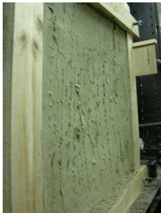
圖 4-5 A3 試體正面壁土呈凹陷狀。
