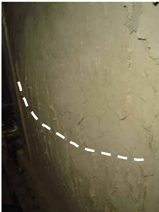
圖 4-5 A3 試體背面壁土凸出狀況。
