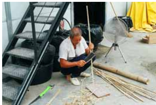
圖 3-24 再依序以柴刀削除竹片內節。
