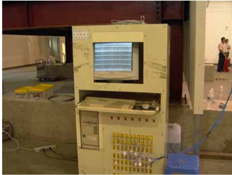
圖 2.3-2 本機械煙控系統火災全尺度實驗之數據存取記錄器
