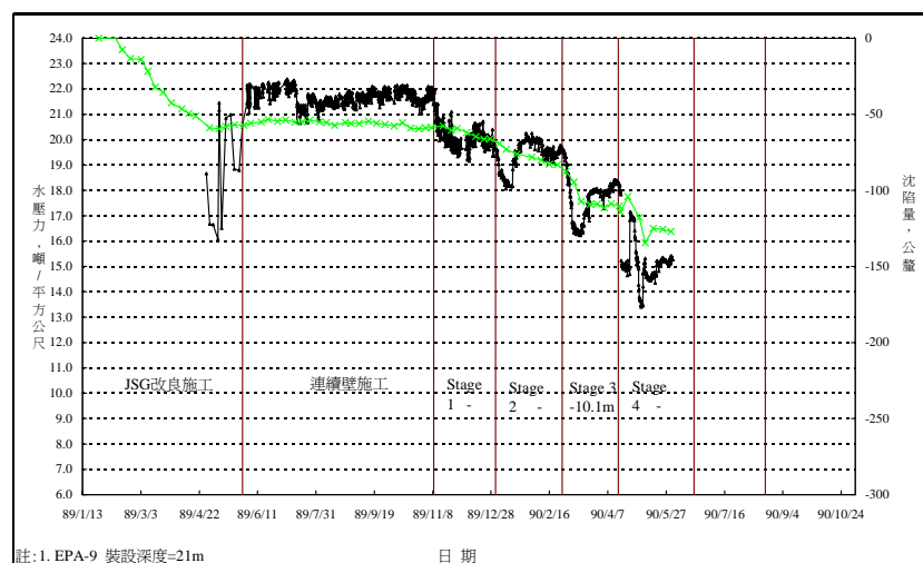
圖 3-5-4 地下水壓與地盤沈陷關係示意圖
