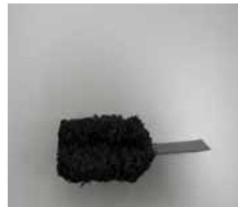
圖 5.4 防火條膨脹情形
