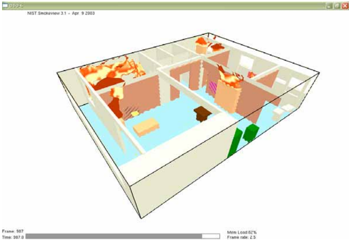
圖 5.75 住戶內部燃燒耗盡情形(987 秒)
