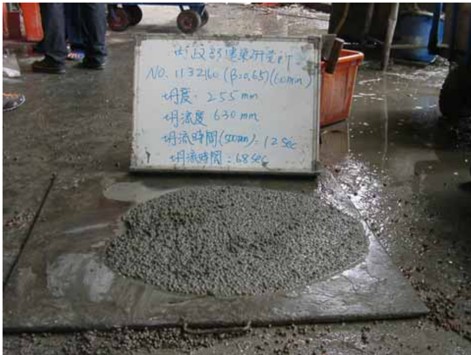
圖 4-4 輕質混凝土坍度及坍流度試驗情況 4
