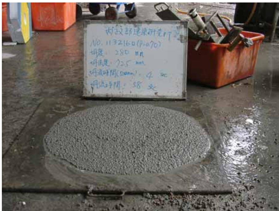
圖 4-5 輕質混凝土坍度及坍流度試驗情況 5
