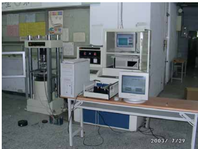
圖 3-4 混凝土抗壓試驗
