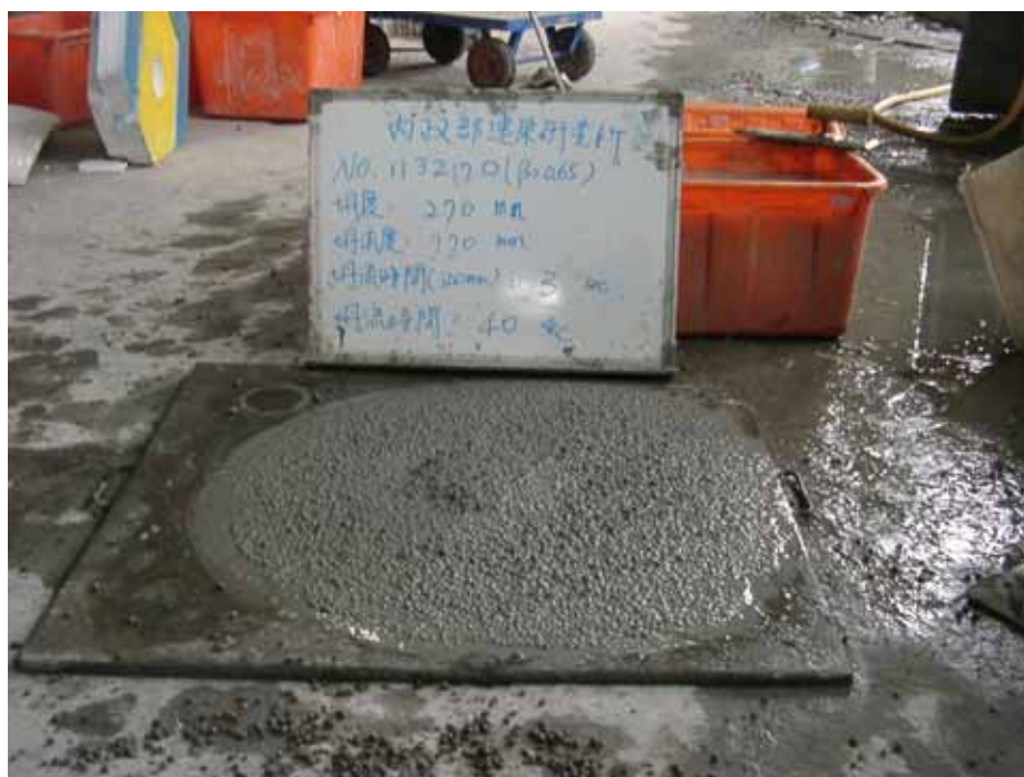
圖 4-11 輕質混凝土坍度及坍流度試驗情況 11
