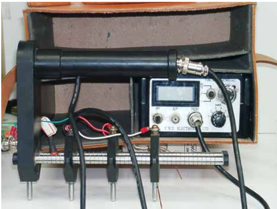
圖 3-6 混凝土電阻量測儀示意圖
