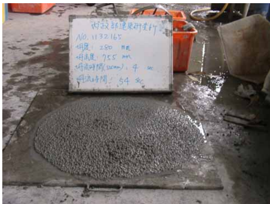
圖 4-7 輕質混凝土坍度及坍流度試驗情況 7
