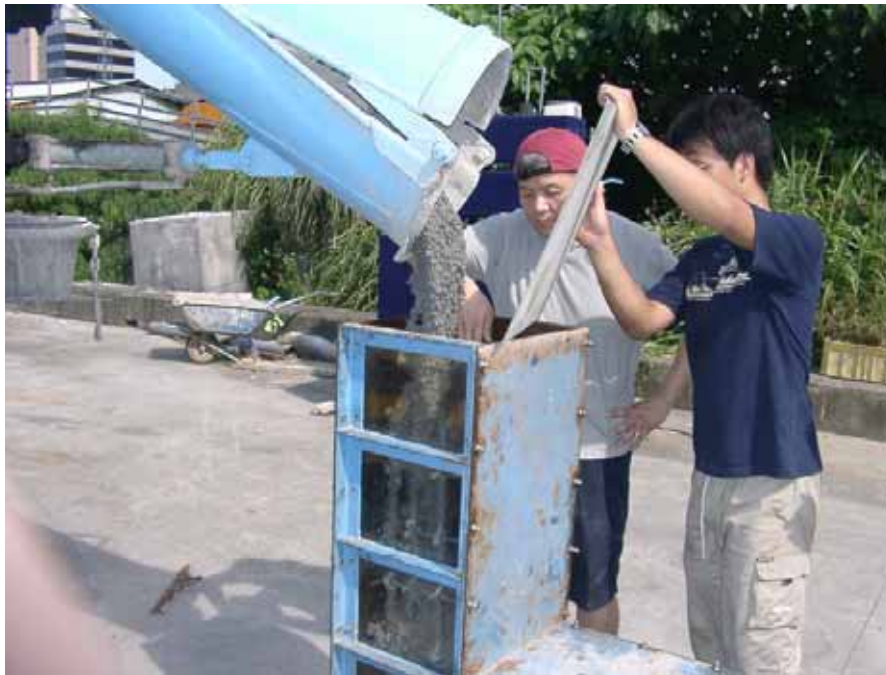
圖 4-30 廠拌凹型試驗-預拌車卸料
