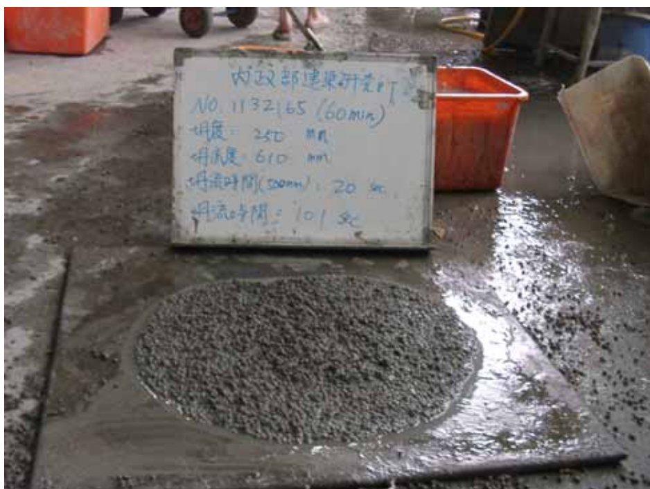
圖 4-8 輕質混凝土坍度及坍流度試驗情況 8
