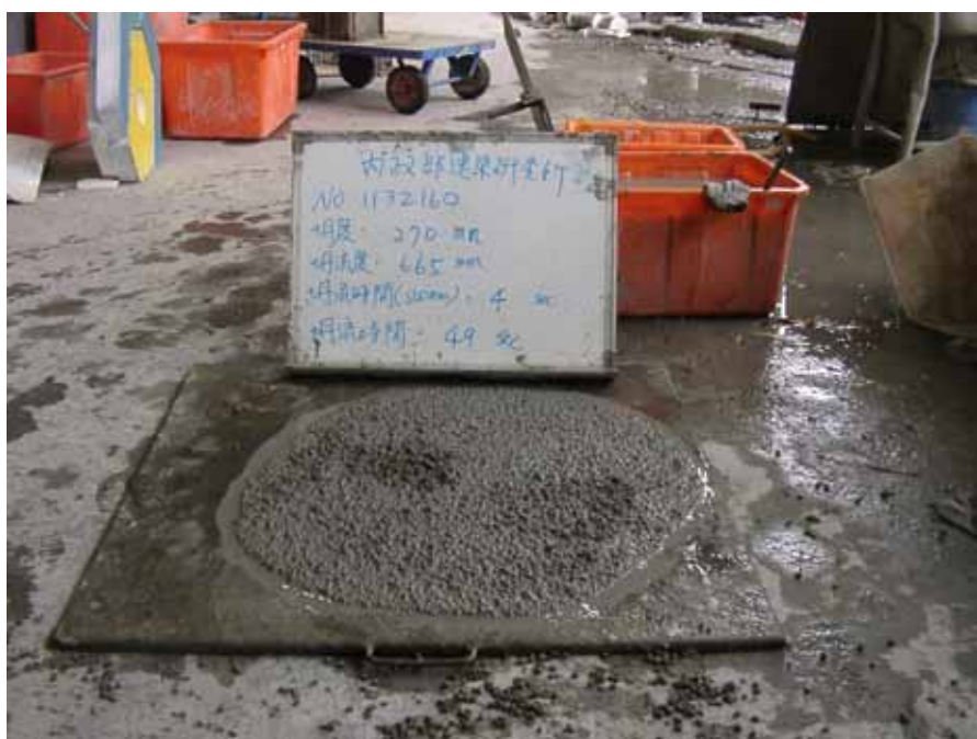
圖 4-1 輕質混凝土坍度及坍流度試驗情況 1
