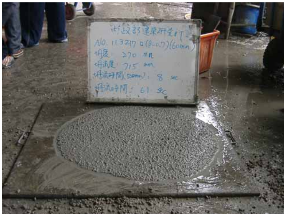
圖 4-14 輕質混凝土坍度及坍流度試驗情況 14
