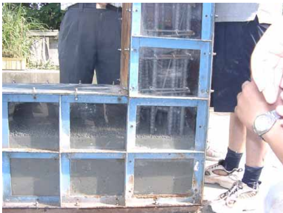
圖 4-32 廠拌凹型試驗-高性能輕質混凝土流動及上升
