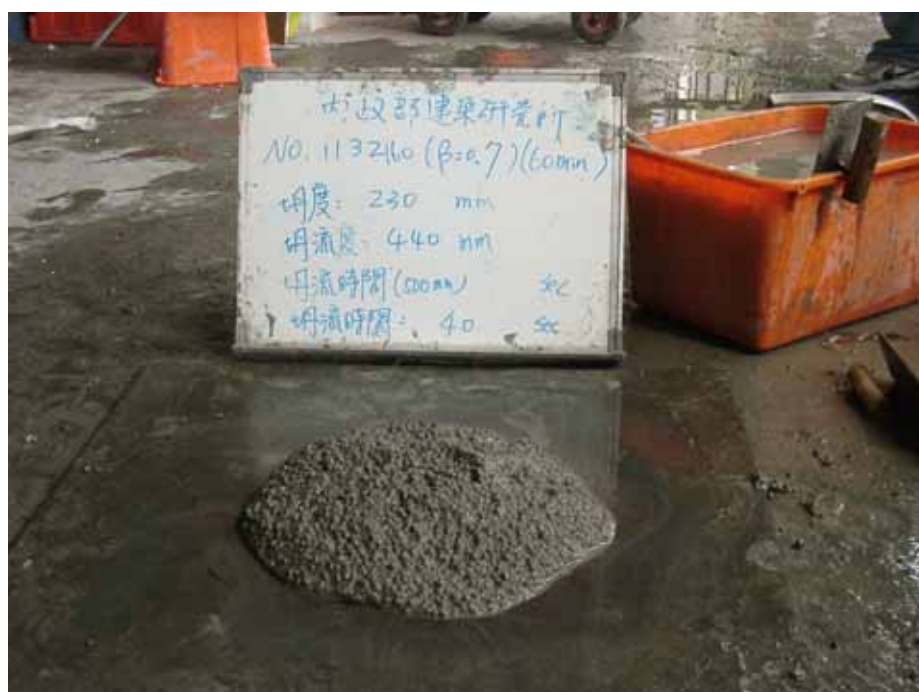
圖 4-6 輕質混凝土坍度及坍流度試驗情況 6
