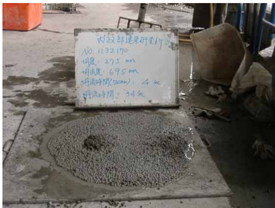
圖 4-9 輕質混凝土坍度及坍流度試驗情況 9
