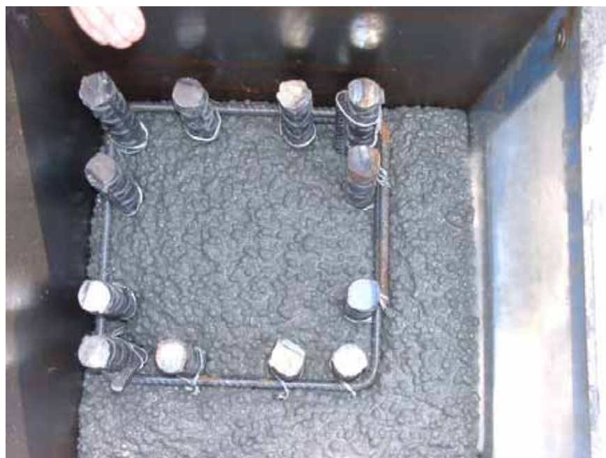
圖 4-34 廠拌凹型試驗-通過雙層鋼筋障礙
