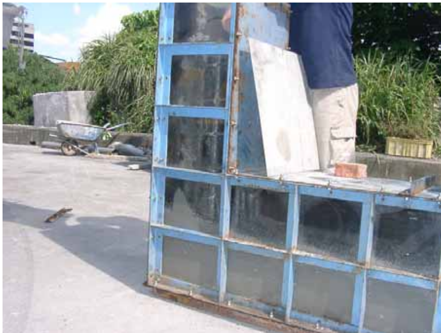
圖 4-31 廠拌凹型試驗-高性能輕質混凝土在凹型模內流動
