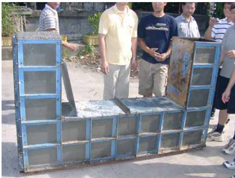
圖 4-35 廠拌凹型試驗-柱內高性能輕質混凝土擠昇完成
