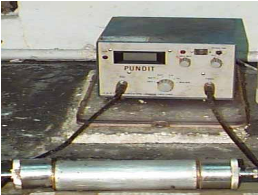
圖 3-5 超音波速量測器
