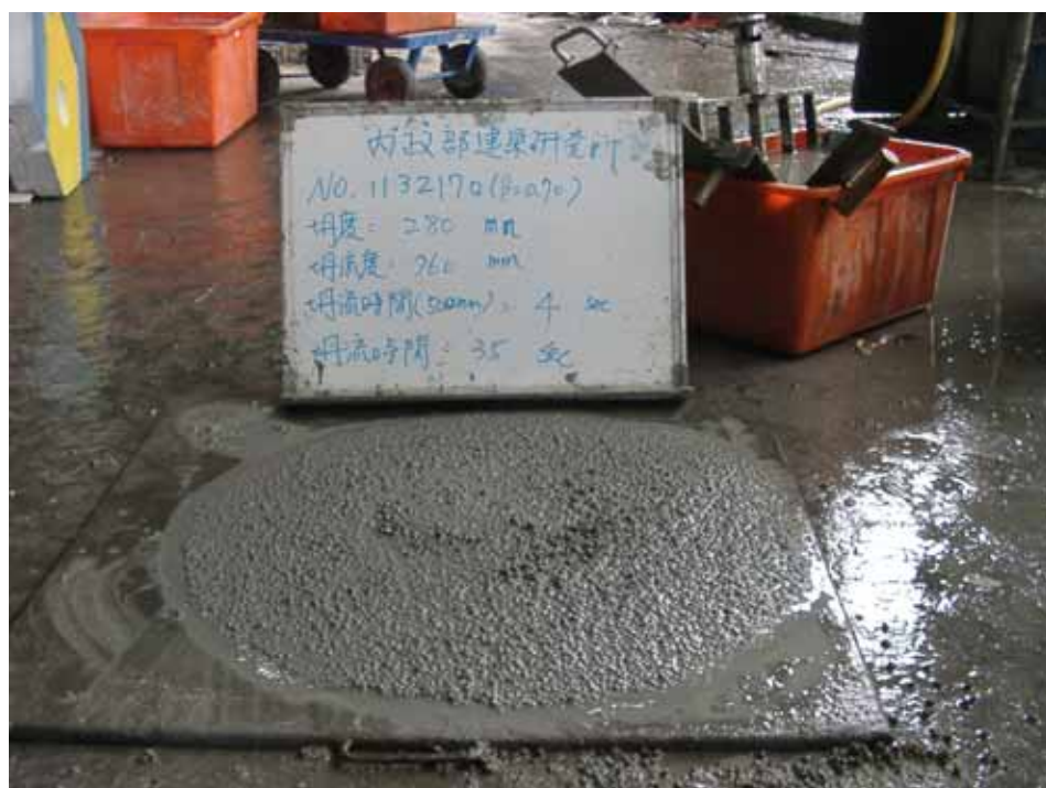
圖 4-13 輕質混凝土坍度及坍流度試驗情況 13
