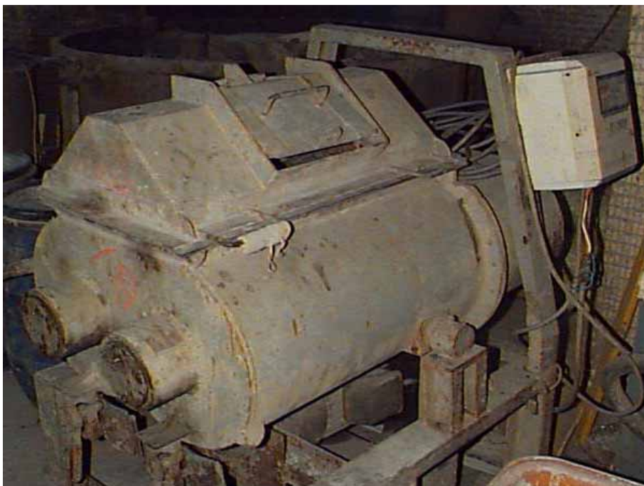
圖 3-2 混凝土水平雙軸拌和機
