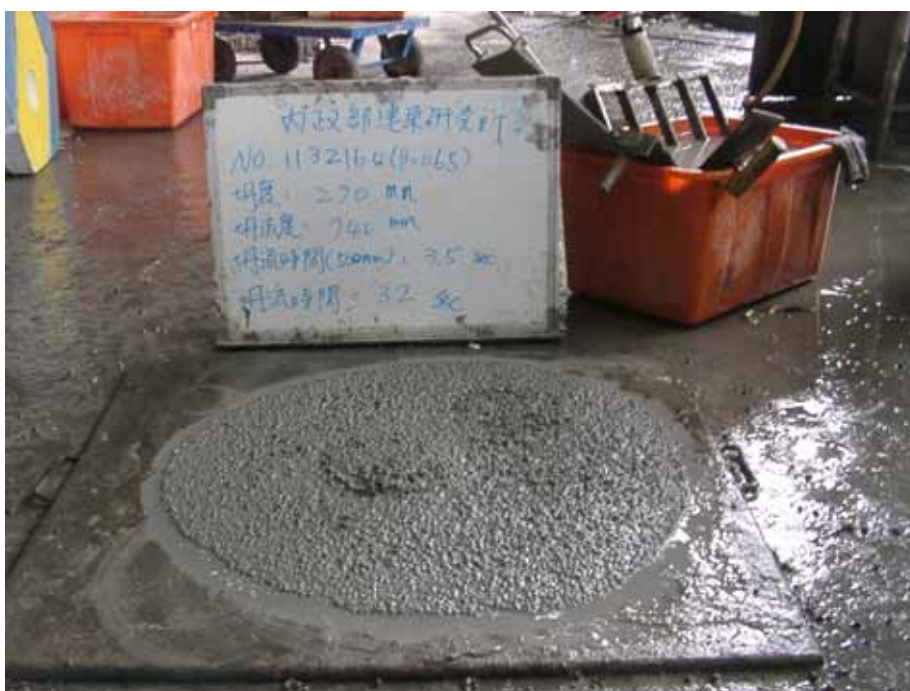
圖 4-3 輕質混凝土坍度及坍流度試驗情況 3
