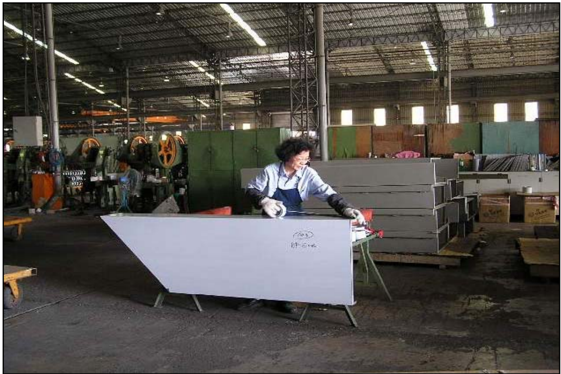
[圖 4.9] 板片檢查包裝作業
