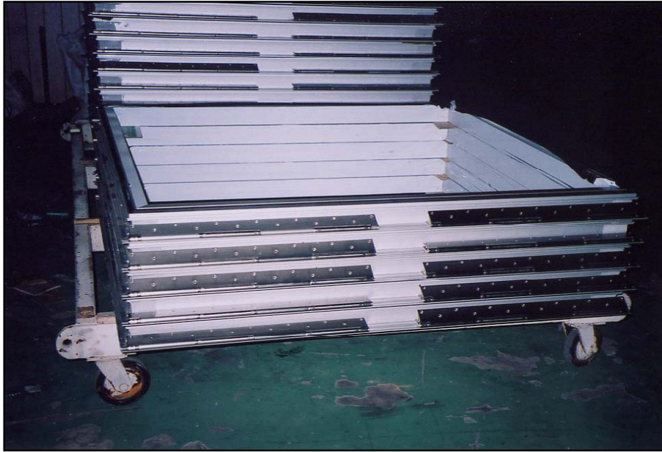
[圖 3.24] 將組立完成之框架堆置以進行小搬運
