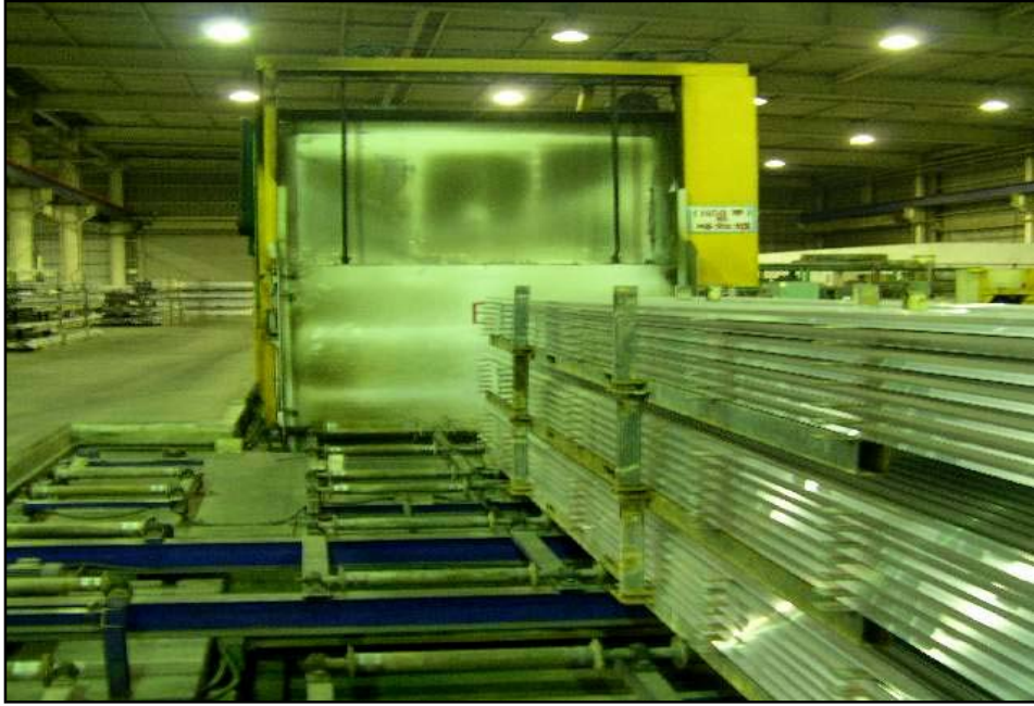
[圖 2.5] 鋁擠型時效熱處理作業
