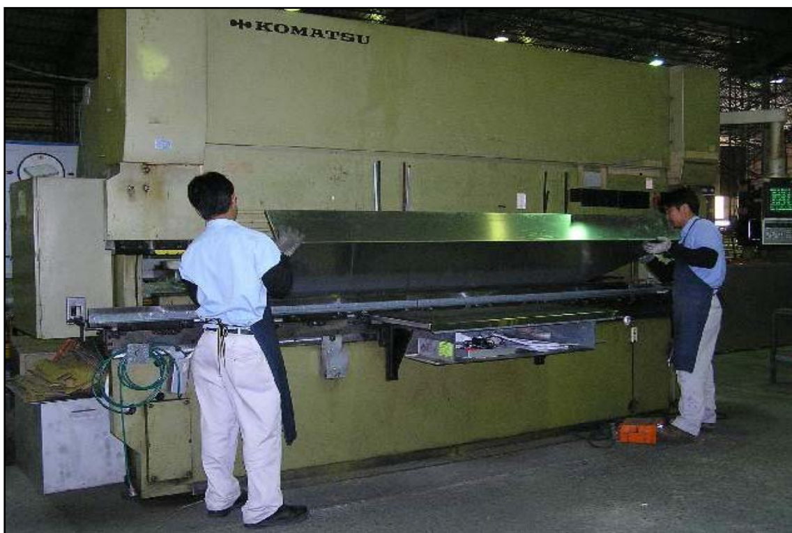
[圖 4.5] 板片彎版作業
