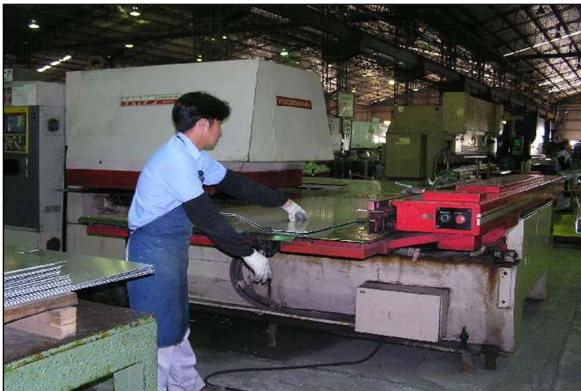
[圖 4.4] 板片沖切作業
