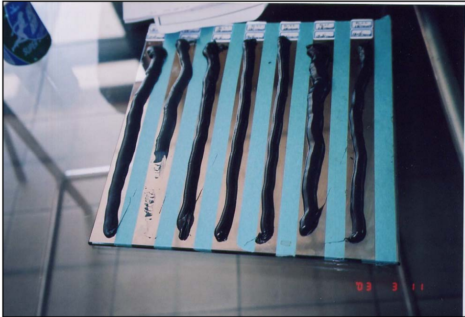
[圖 3.22] 結構砂膠性能檢測
