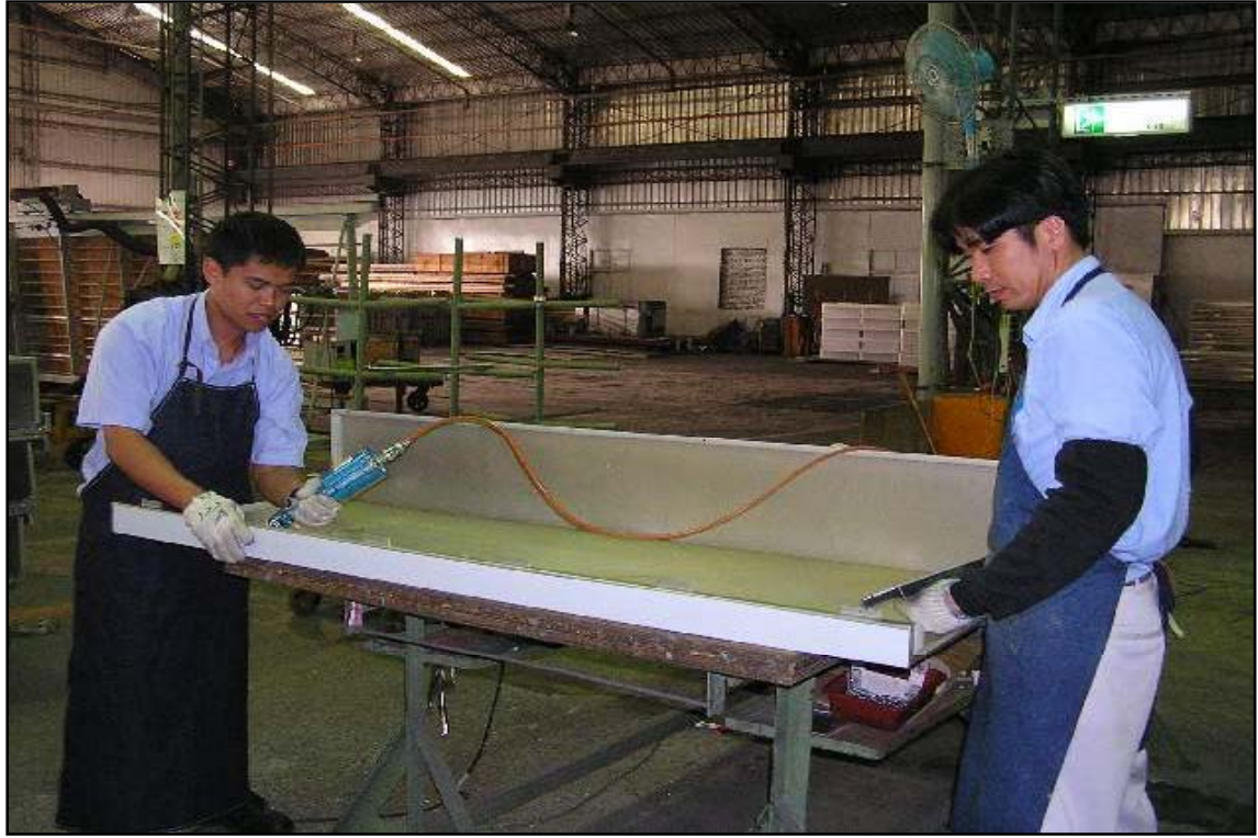
[圖 4.10] 板片組立作業
