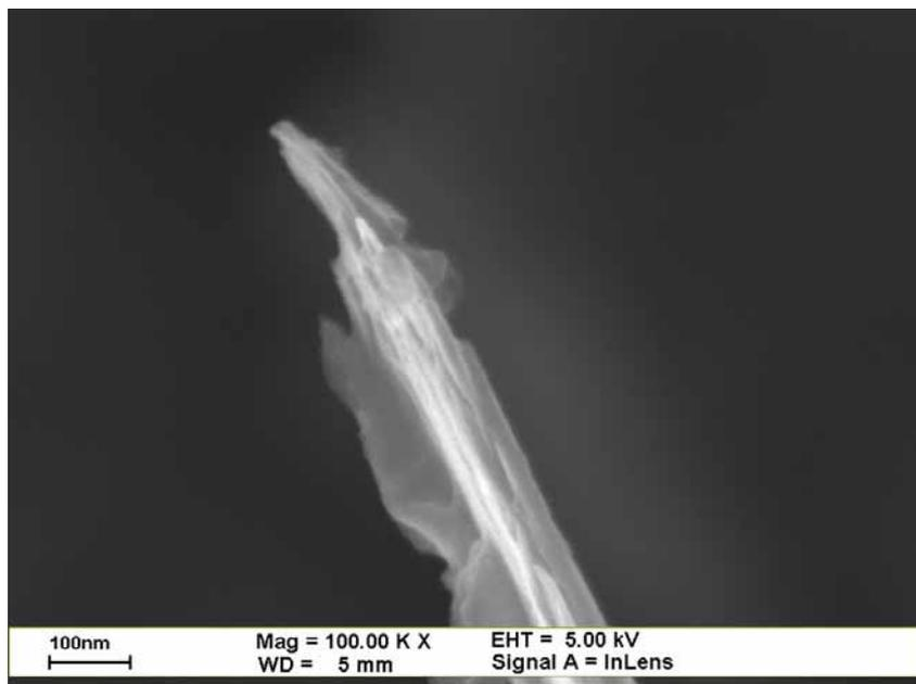
圖 2.30 BH30005N 系統下捲成棒狀奈米結構末端多層石墨結構之 SEM 圖
