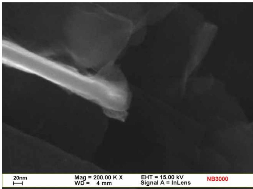
圖 2.28 BH30003N 系統下奈米管狀結構末端之 SEM 圖
