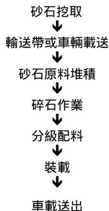
圖 3-2 建築用砂石生產流程圖
