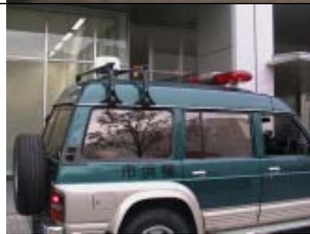
橫濱市役所的公務車內所配備導航及訊息通報系統，該設備除具導航的功能外，也可透過與行政無線電系統及 DoCoMo 民間業者之無線電信網路與危機管理應變中心座互動式的雙向通訊與資料傳輸
