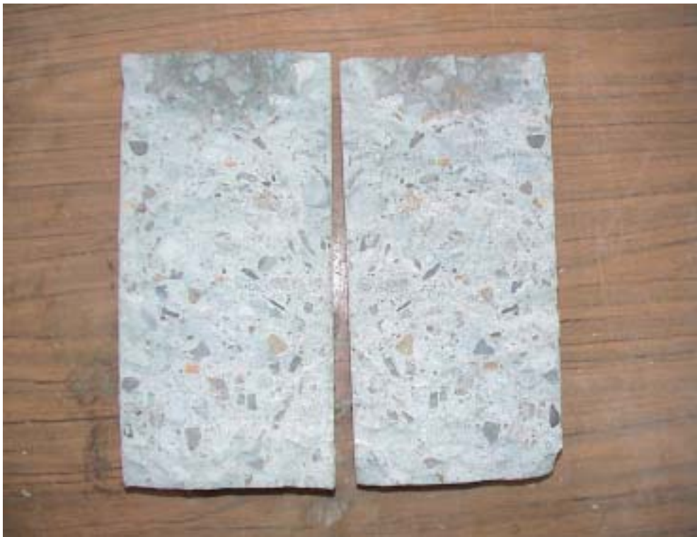
照片 4-6.20 常重混凝土劈裂試驗破壞
