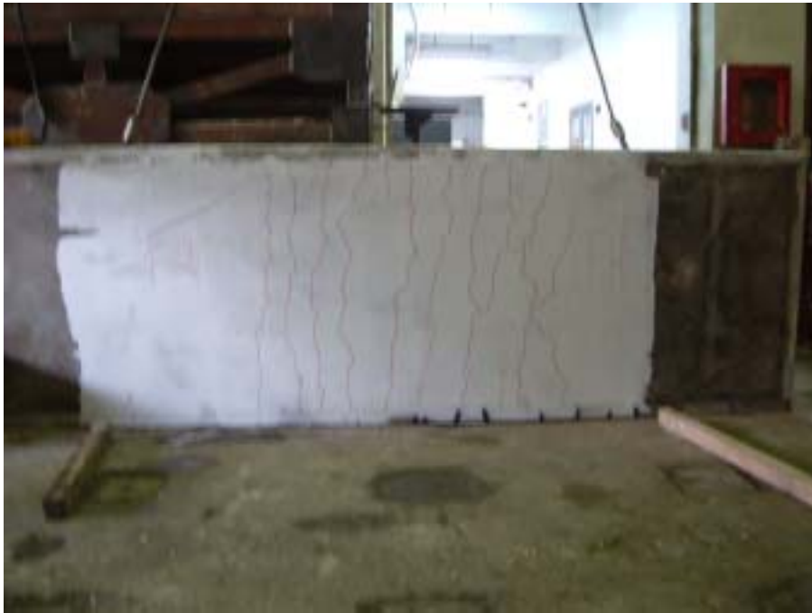
照片 4-4.29 SF2 試體試驗後裂縫發展情形
