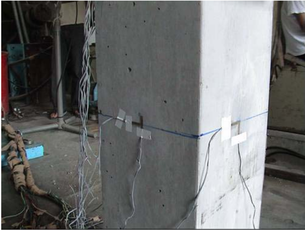
照片 4-5.7 柱試體混凝土應變計一
