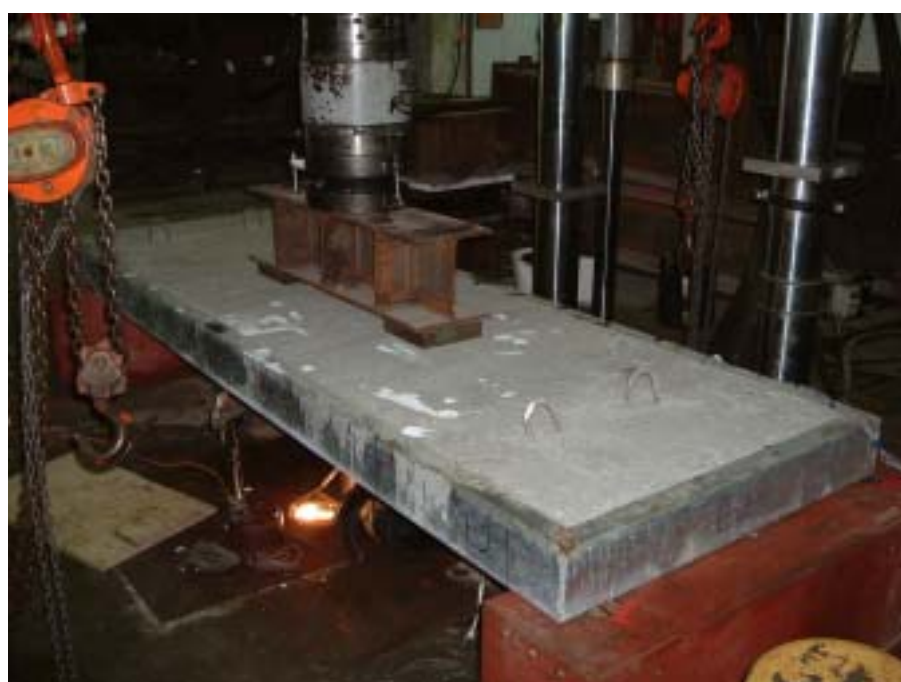
照片 4-4.4 MTS 安裝定位
