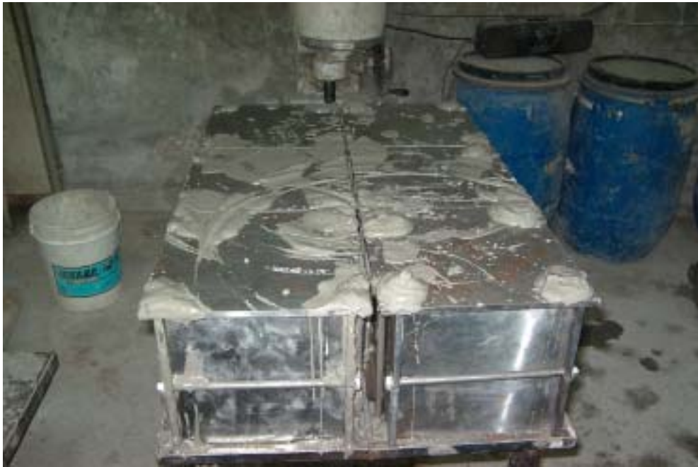
照片 3-3.3 漿體由排漿孔流出表示灌漿完成
