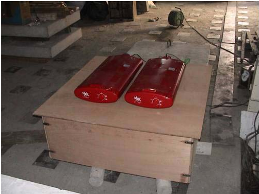
照片 4-6.14 牆試體熱傳試驗安裝二
