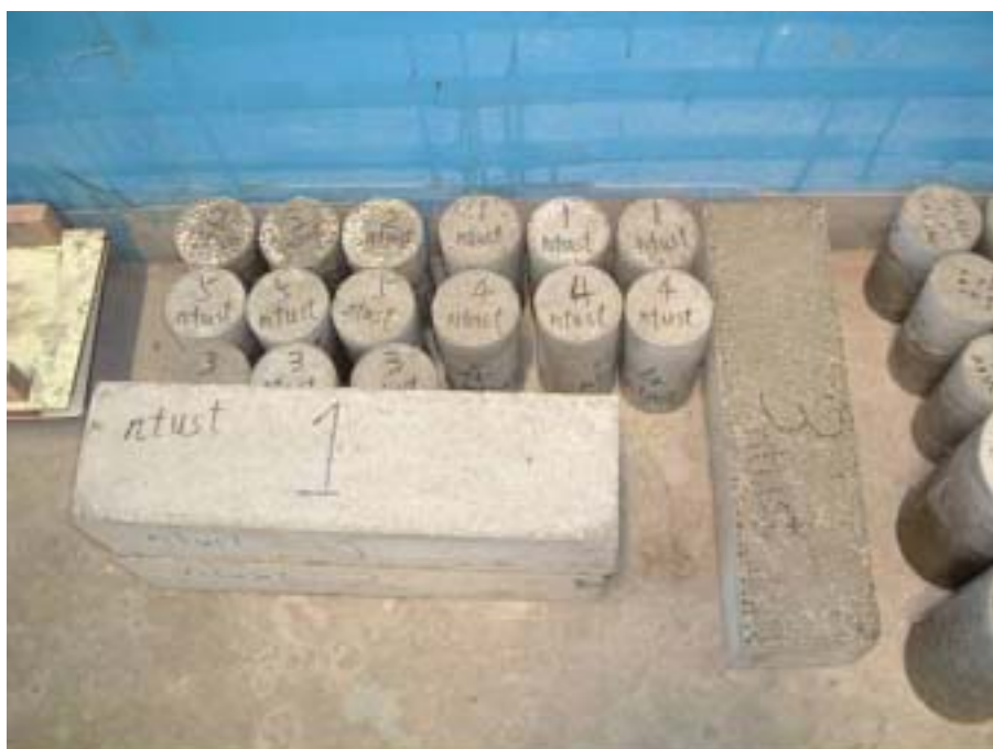
照片 4-4.3 抗壓及抗彎試體
