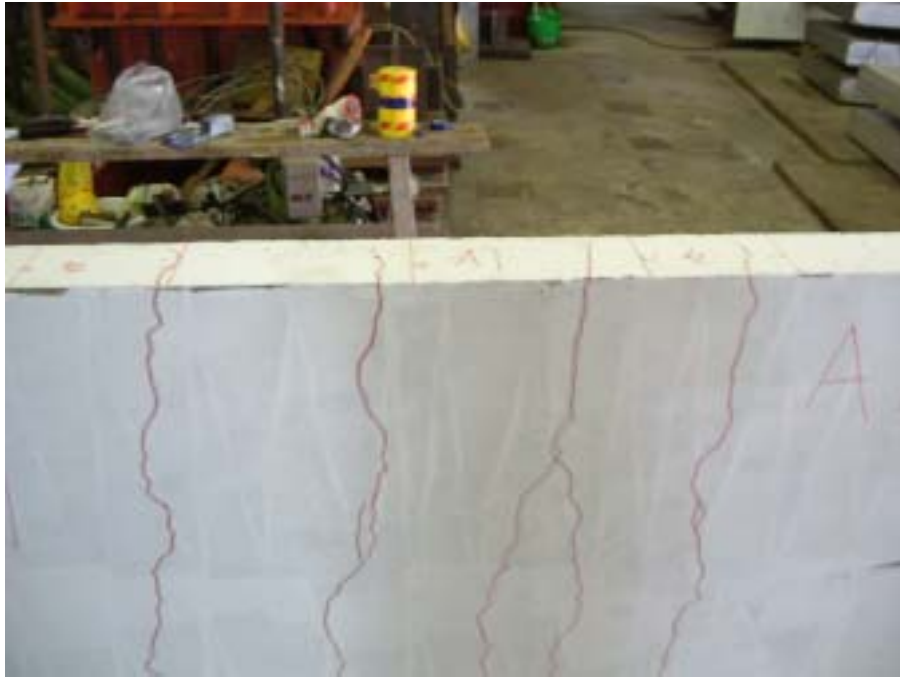
照片 4-4.15 SA1 試體試驗後裂縫發展情形
