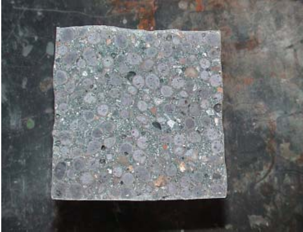
照片 4-6.17 抗彎試驗破壞
