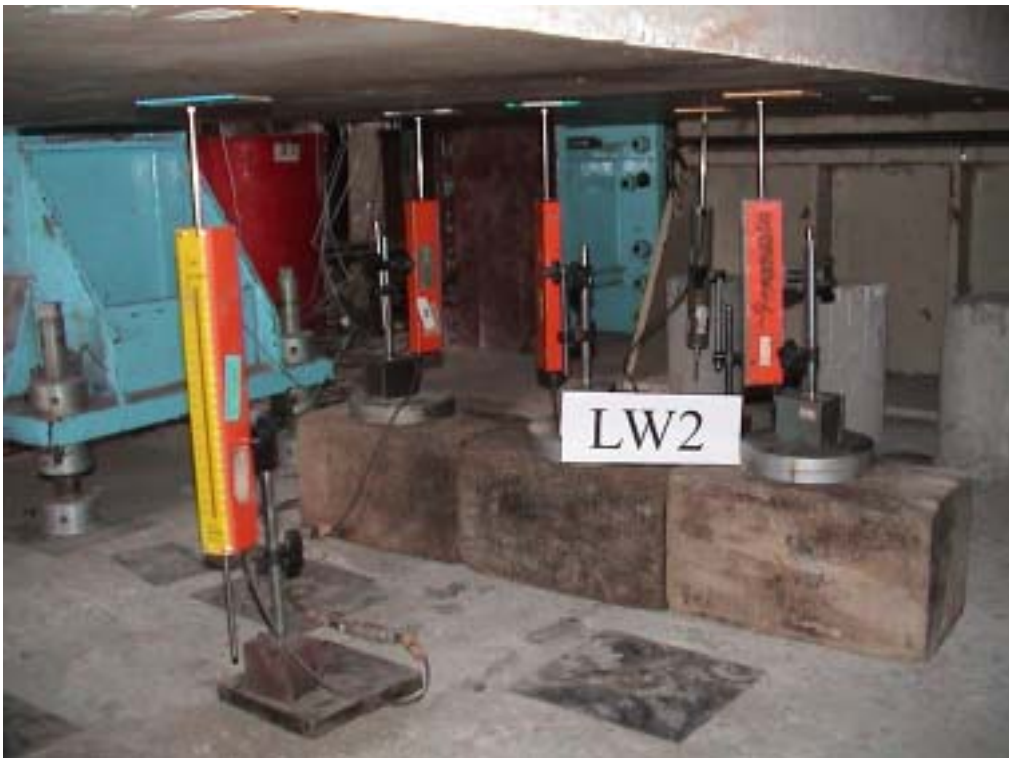
照片 4-6.12 牆試體試驗安裝四
