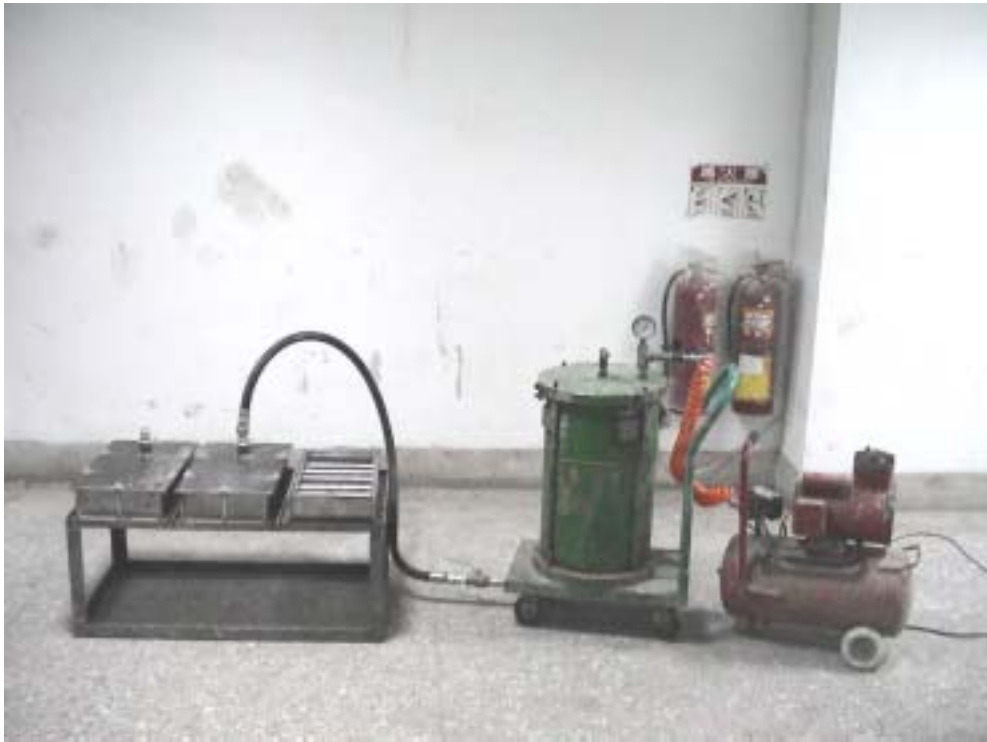
照片 3-4.2 中空輕質混凝土版試驗設備
