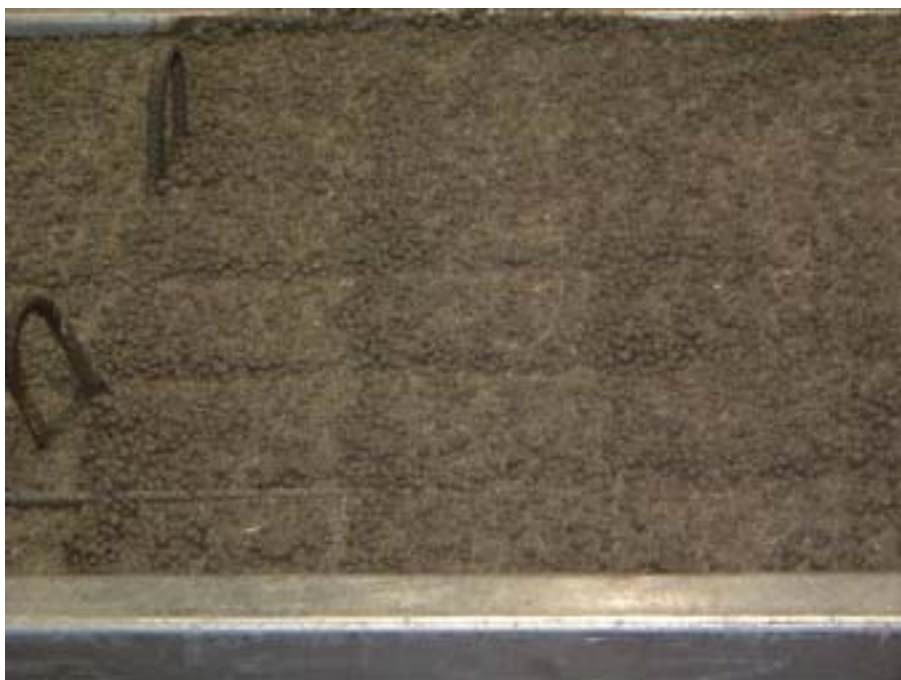
照片 4-2.19 使用配比 92.06.06-3 配比灌製構件時有顆粒隆起現象(一)
