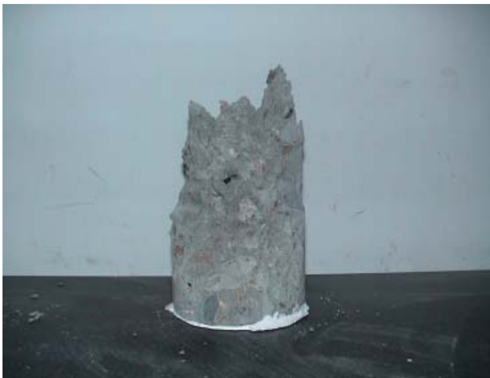
照片 4-6.16 常重混凝土抗壓試驗破壞
