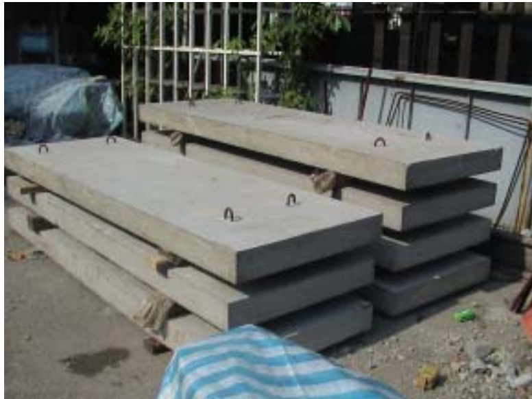
照片 4-6.6 抗彎試驗牆試體在試驗室存放之情形(二)
