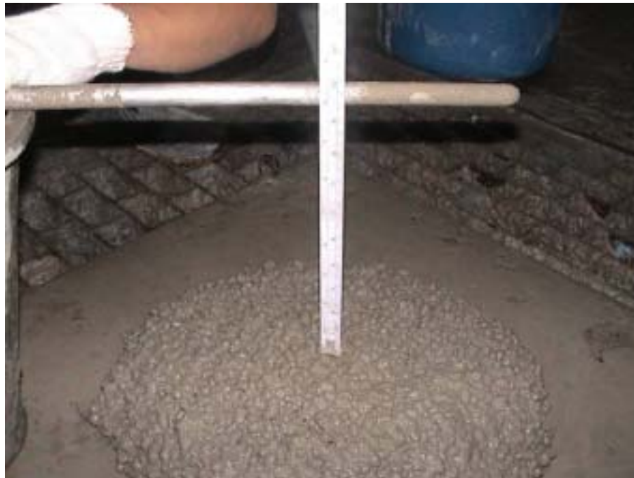
照片 4-2.11 鏟平試驗配比 92.06.17-1 配比之坍度
