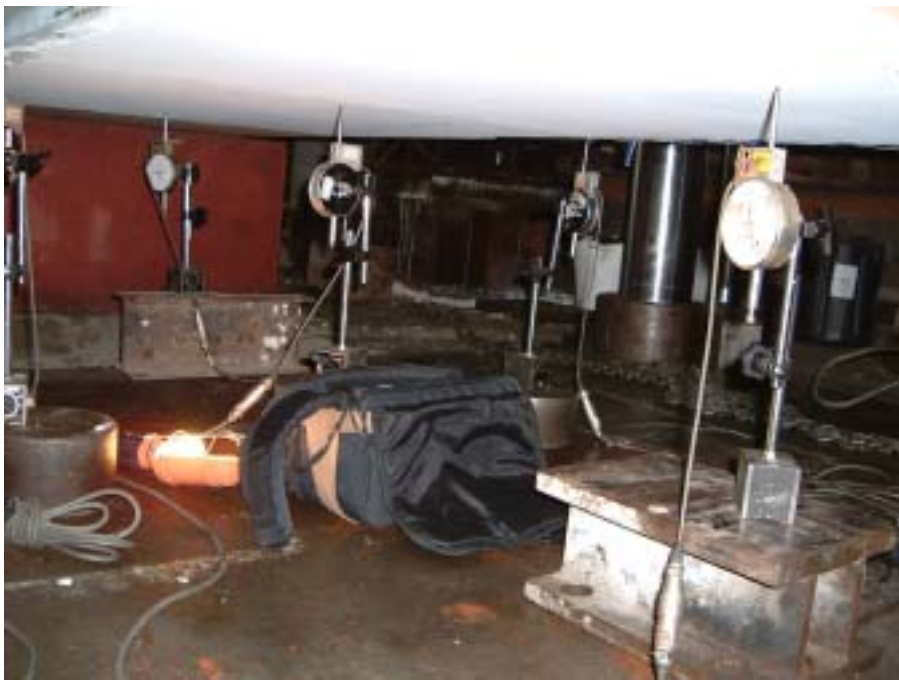
照片 4-4.6 V8 監錄裂縫發展情形
