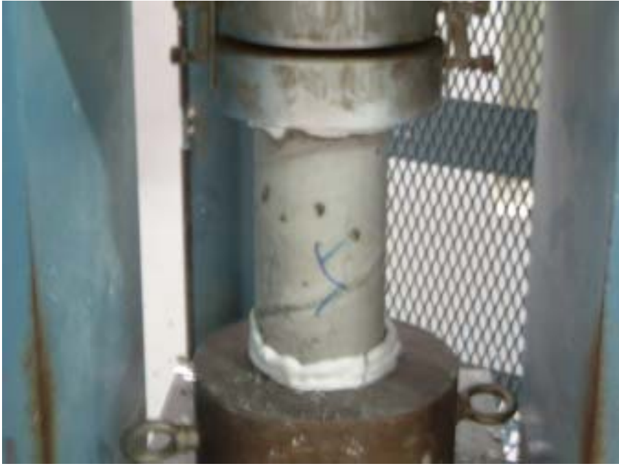
照片 4-4.9 抗壓試體試驗
