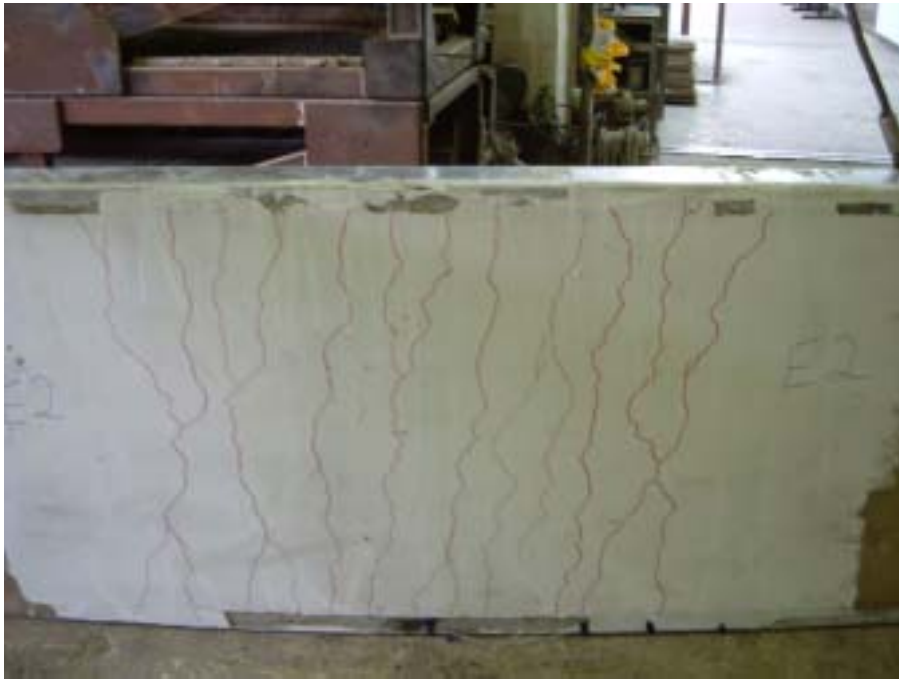
照片 4-4.27 SE2 試體試驗後裂縫發展情形
