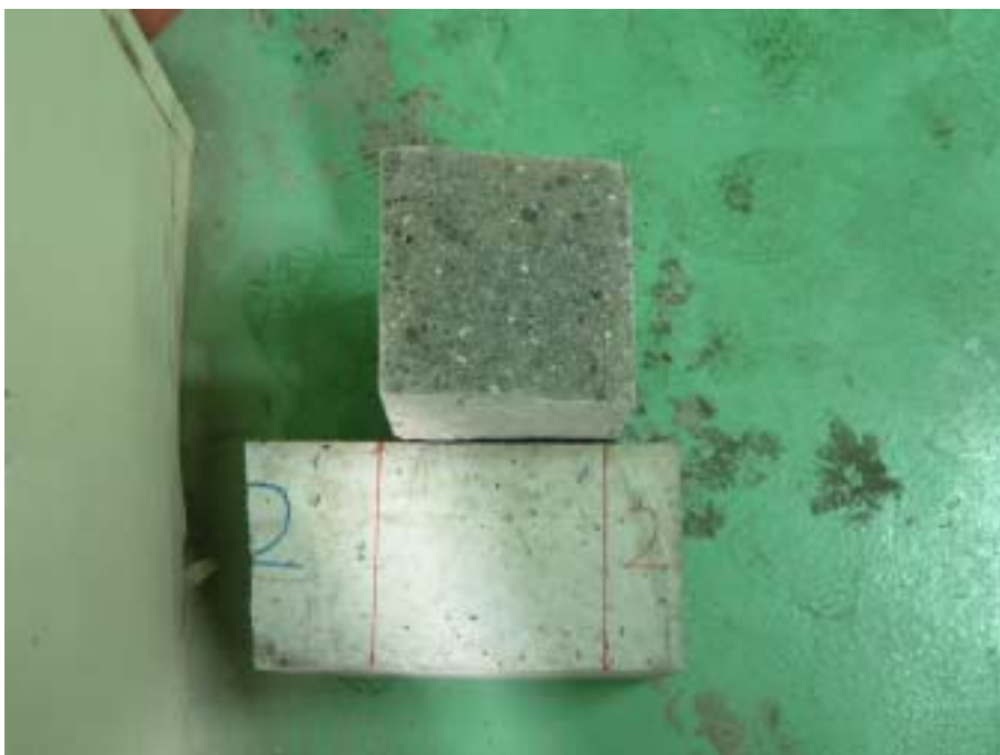
照片 4-4.12 抗彎試體試驗後
