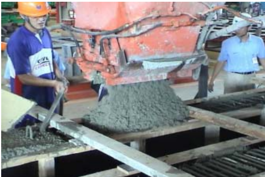
照片 4-3.13 澆置梁試體混凝土情形
