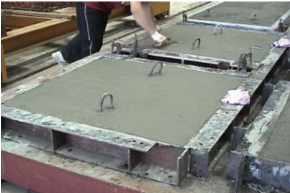
照片 4-6.4 隔熱試驗牆試體灌注之情形
