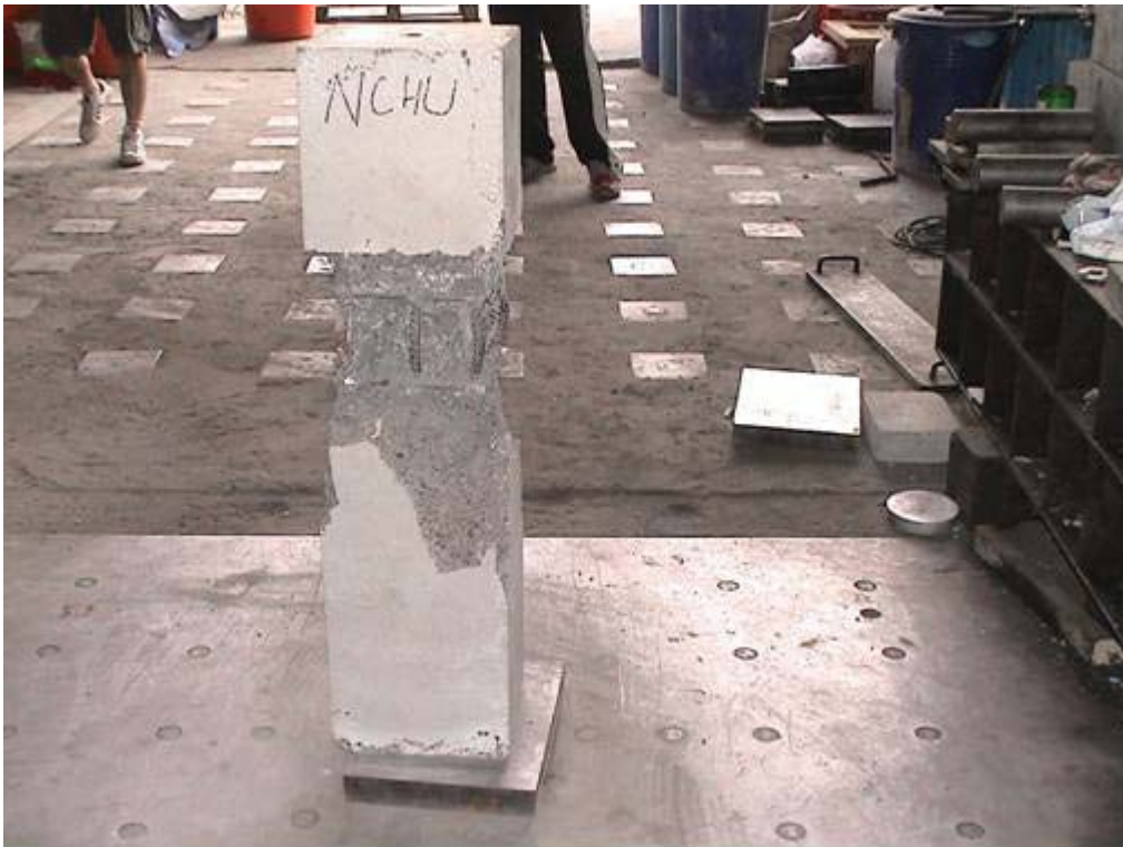
照片 4-5.10 LC2 破壞狀況
