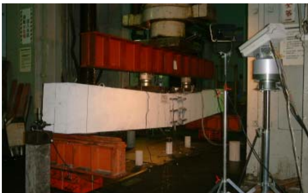
照片 4-3.21 試體 NC-1 到達破壞階段之情形
