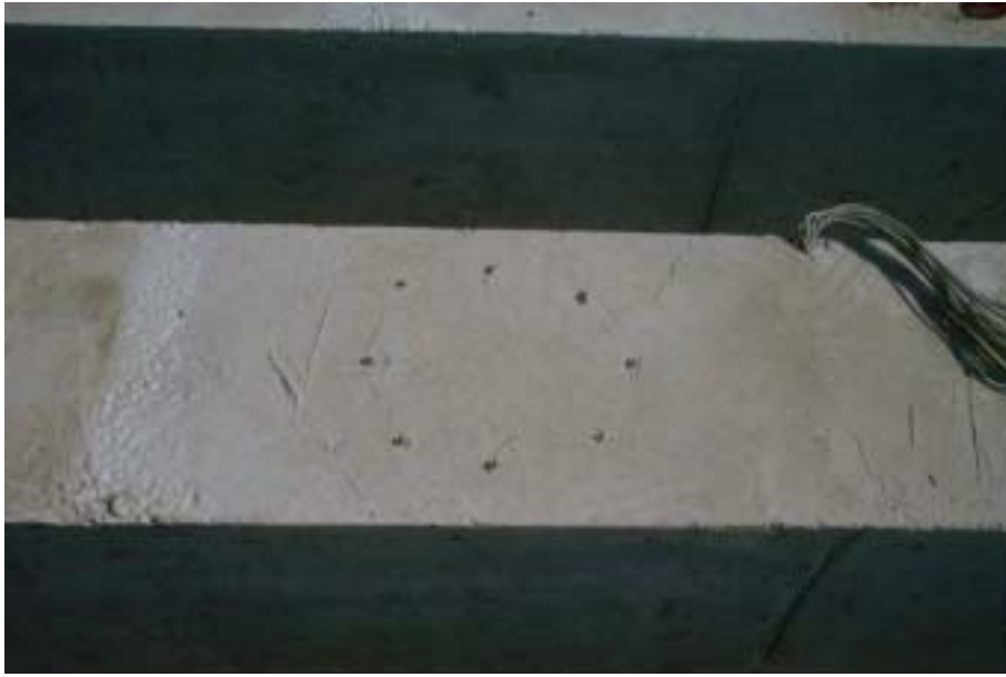
照片 4-3.18 混凝土硬固後梁試體表面情形
