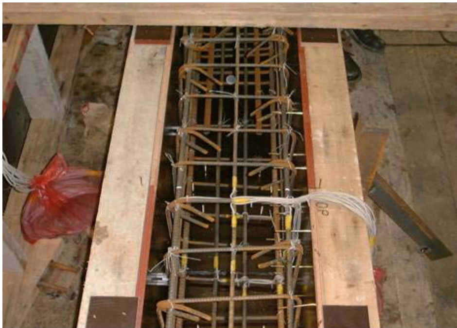
照片 4-3.5 LA 系列試體測試區之鋼筋及應變計配置圖
