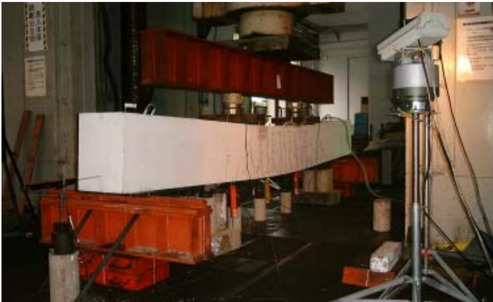
照片 4-3.19 試體 LA-1 到達破壞階段之情形
