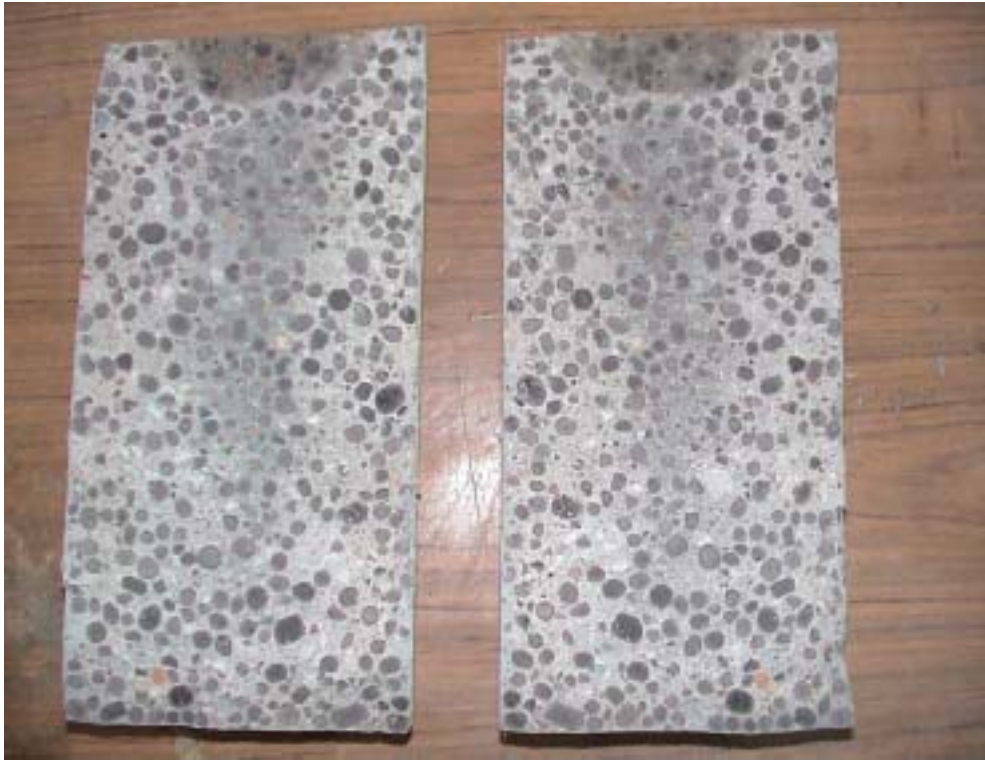
照片 4-6.19 輕質混凝土劈裂破壞
