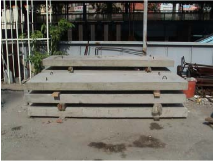
照片 4-6.5 抗彎試驗牆試體在試驗室存放之情形(一)
