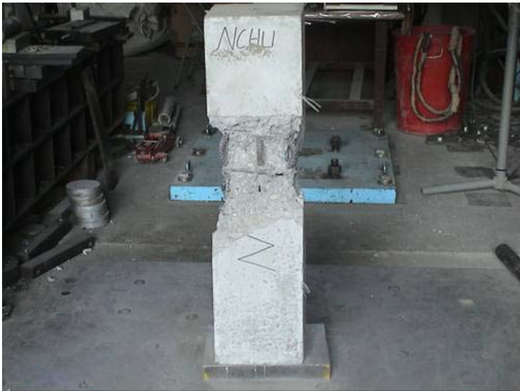
照片 4-5.12 NC2 破壞狀況
