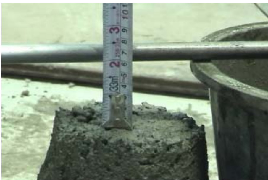
照片 4-3.9 輕質骨材混凝土坍度試驗
