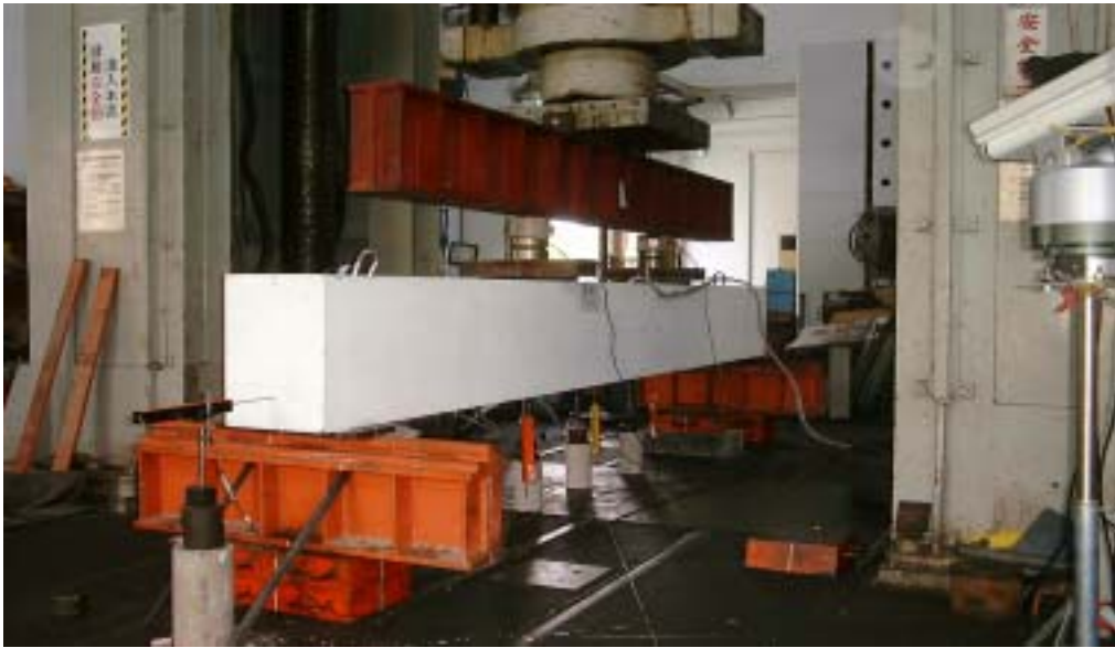
照片 4-3.1 加載設備 (純彎矩)
