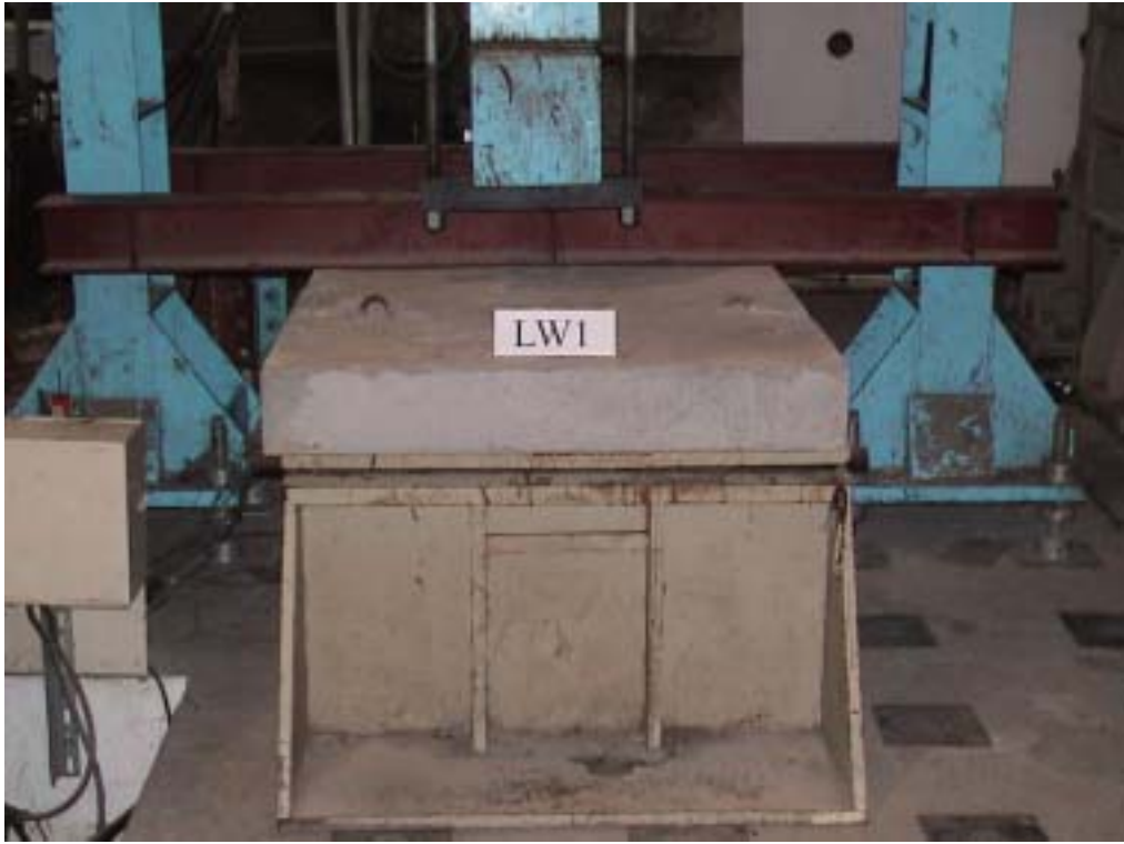
照片 4-6.9 牆試體試驗安裝一
