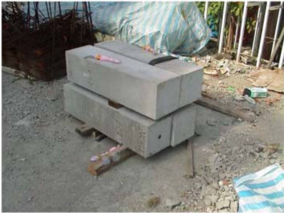
照片 4-5.4 柱試體在試驗室存放之情形
