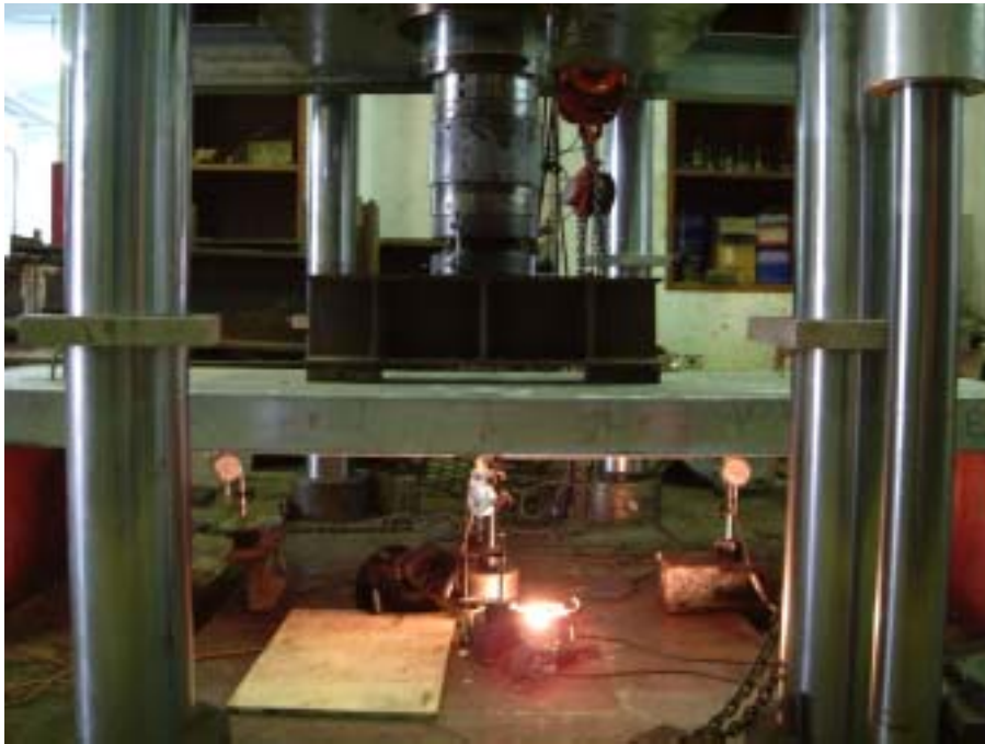
照片 4-4.5 位移計安裝定位
