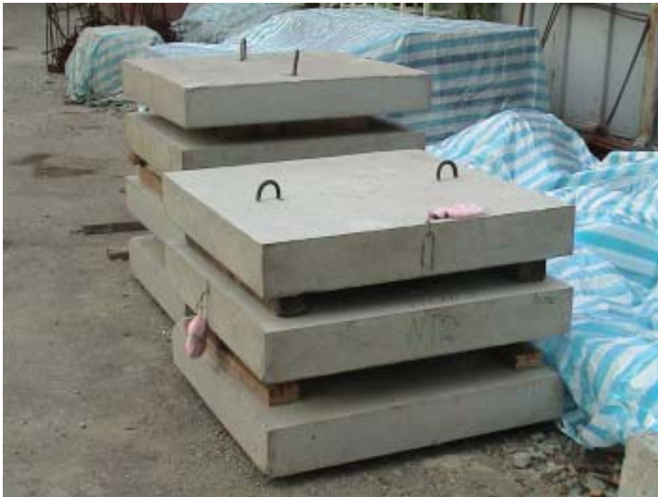
照片 4-6.7 隔熱試驗牆試體在試驗室存放之情形(一)
