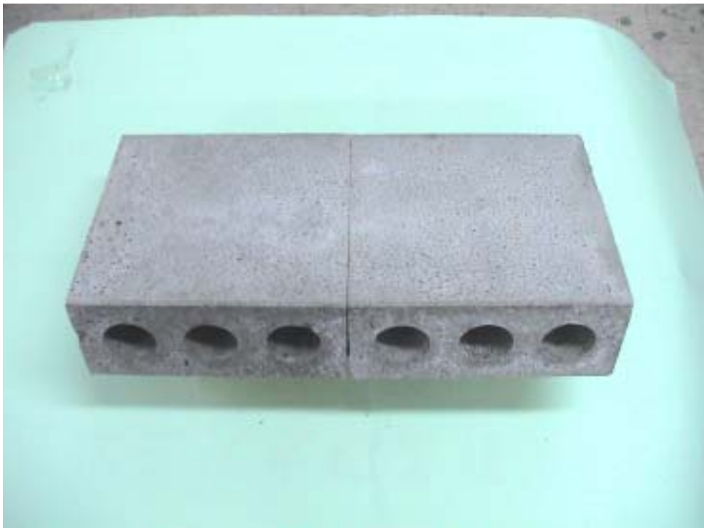
照片 3-4.5 中空輕質混凝土版成品表面光滑平整
