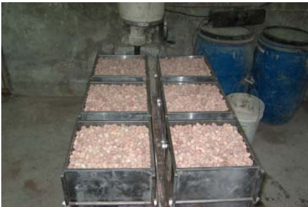
照片 3-3.2 先以絕乾輕質骨材填滿模具
