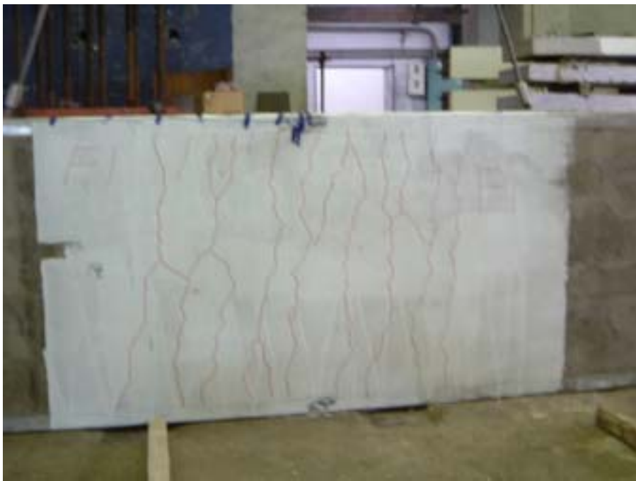
照片 4-4.28 SF1 試體試驗後裂縫發展情形
