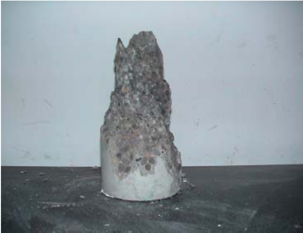
照片 4-6.15 輕質混凝土抗壓試驗破壞
