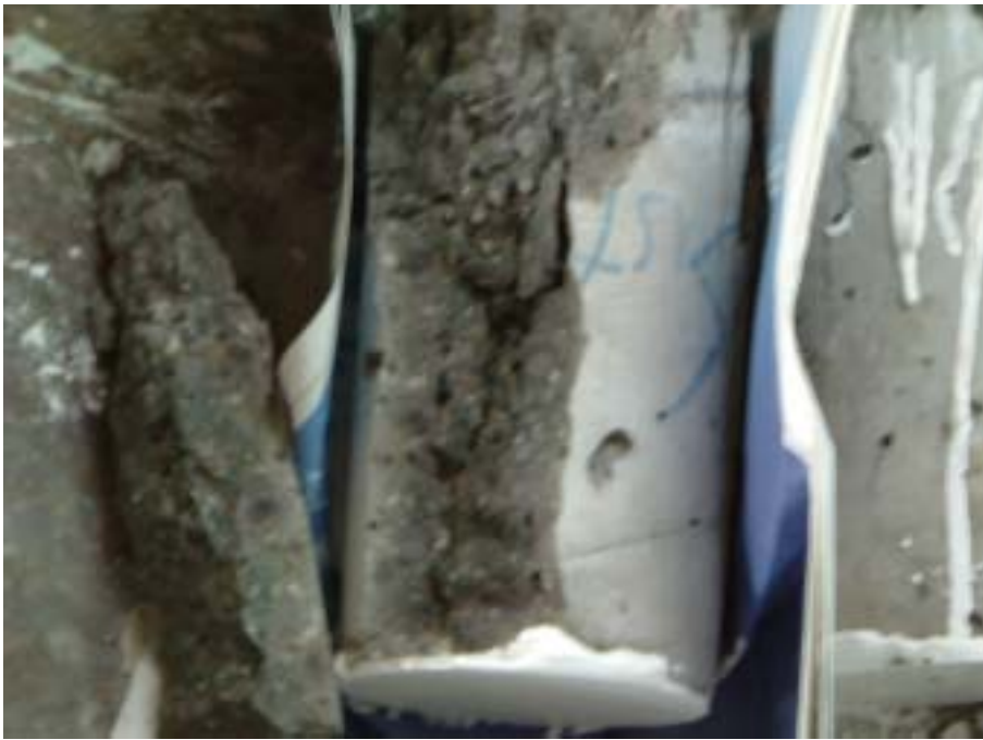
照片 4-4.10 抗壓試驗後之試體
