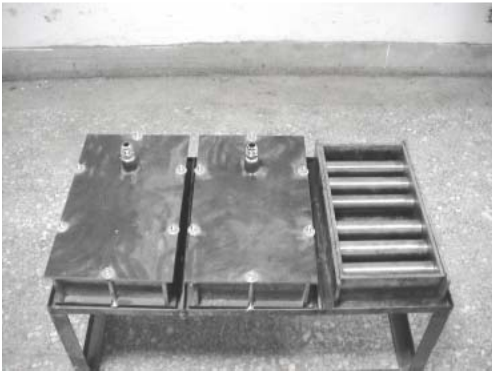
照片 3-4.3 中空輕質混凝土版模具
