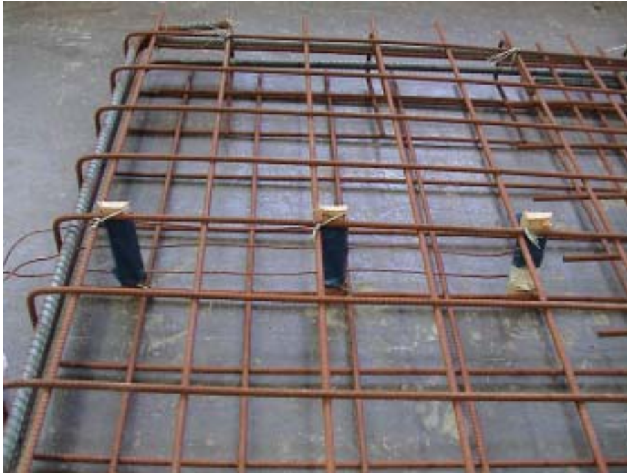
照片 4-6.1 隔熱試驗牆試體之配筋
