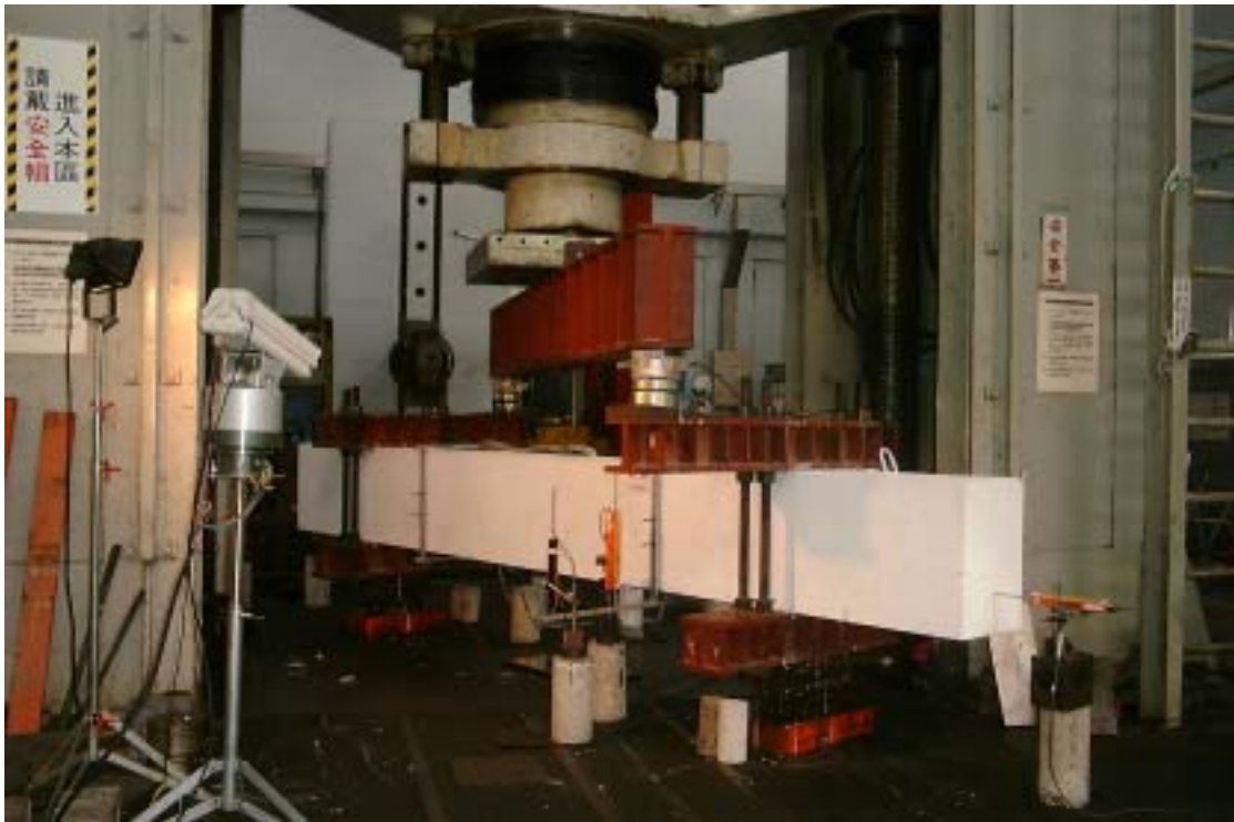
照片 4-3.3 加載設備 (彎矩與扭矩組合載重)
