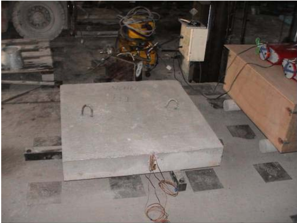
照片 4-6.13 牆試體熱傳試驗安裝一
