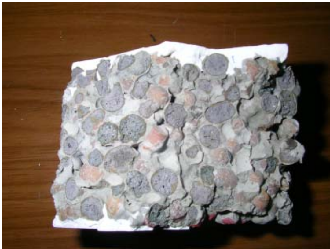
照片 3-4.1 試體受火害抗壓後破裂面
