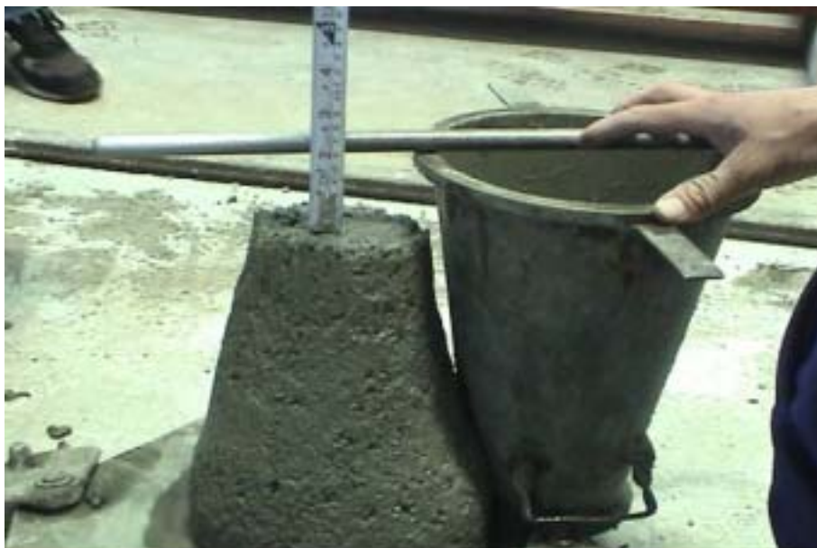
照片 4-3.8 輕質骨材混凝土坍度試驗
