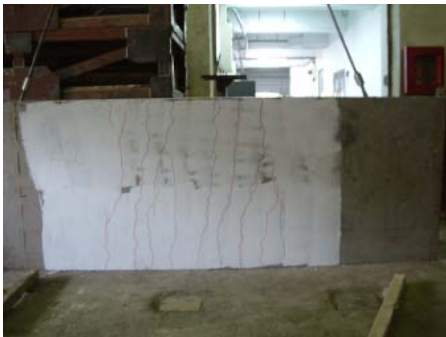
照片 4-4.16 SA2 試體試驗後裂縫發展情形
