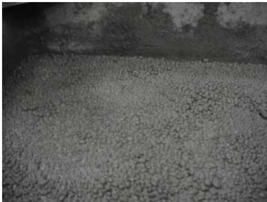
照片 4-2.13 鏟平試驗配比 92.06.17-1 下經努力鏟平後 仍有顆粒浮起現象(一)
