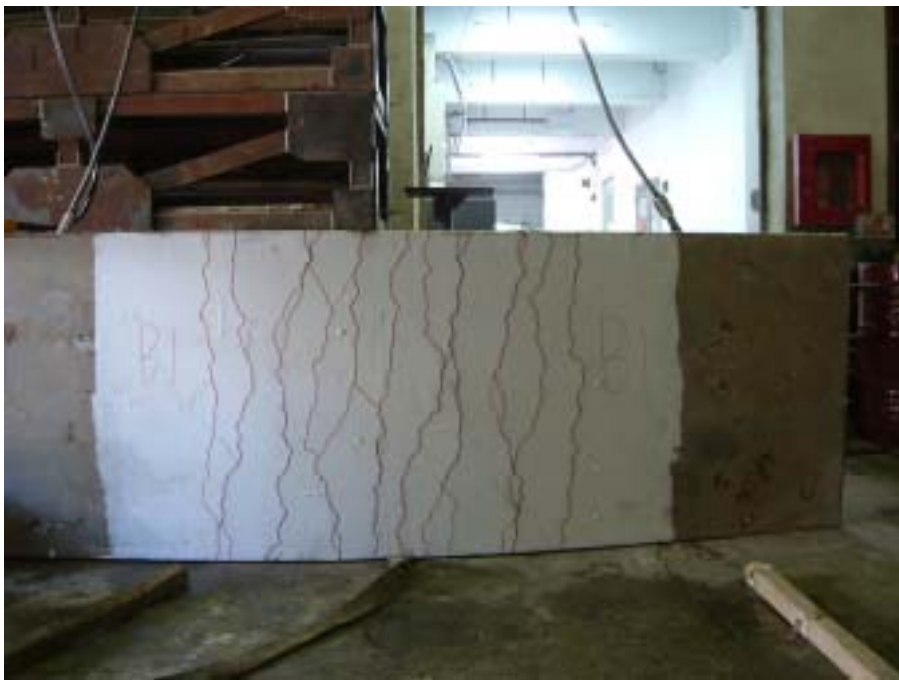
照片 4-4.18 SB1 試體試驗後裂縫發展情形
