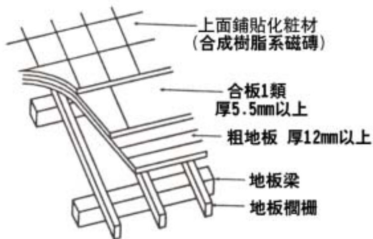
圖 6.1-5(a) 雙重地板基材地板
