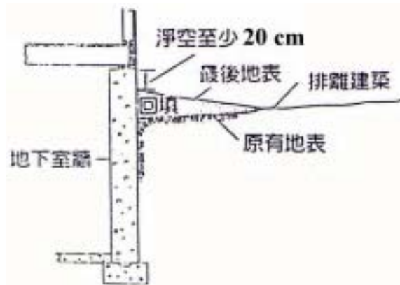
圖 2.6 斜坡地表以利排水
