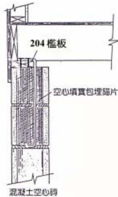
圖 3.2 樓板系統錨定于混凝土磚基牆
