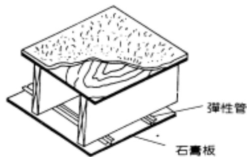
圖 8.6 由彈性管支撐、具地毯、底墊、合板地板底板、及天花板石膏板之地板-天花板結構，STC 值為 46 至 48。
