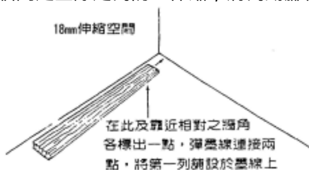
圖 6.13 離牆 18mm 處開始釘著條形地板
