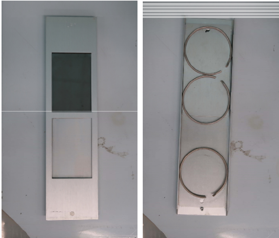
圖 3-5 試驗樣本安裝於試驗機之夾具上(a)夾具劣化曝露面(b)夾具背側固定面 (資料來源：本研究整理)
