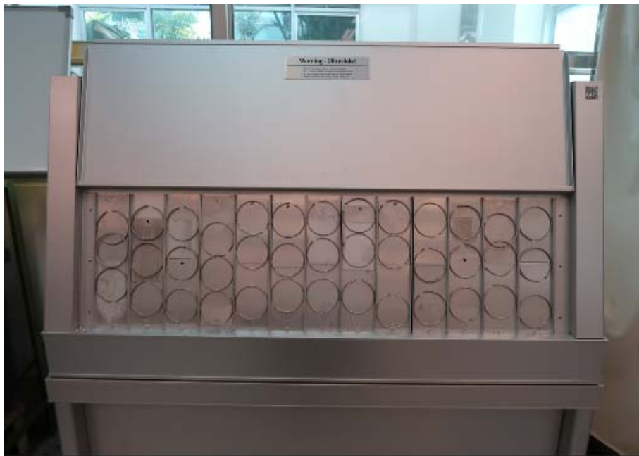
圖 3-6 樣本夾具安裝於 QUV 試驗機中間位置上準備劣化實驗 (資料來源：本研究整理)
