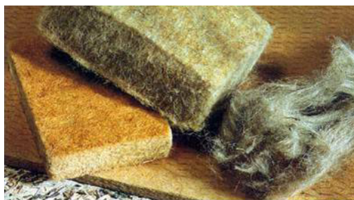
圖2-7.3 取代化學發泡材料的天然纖維隔熱材
