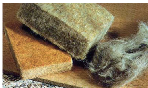
圖2-7.3 取代化學發泡材料的天然纖維隔熱材
