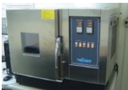
圖三之 3 JIS 標準之測試用恆溫恆濕箱一例(圖片由蔡耀賢老師提供)
