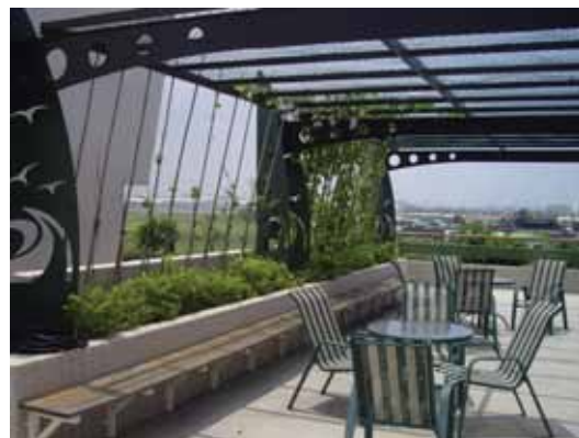
圖5.68 屋頂花架以爬藤綠化，並達到屋頂隔熱
