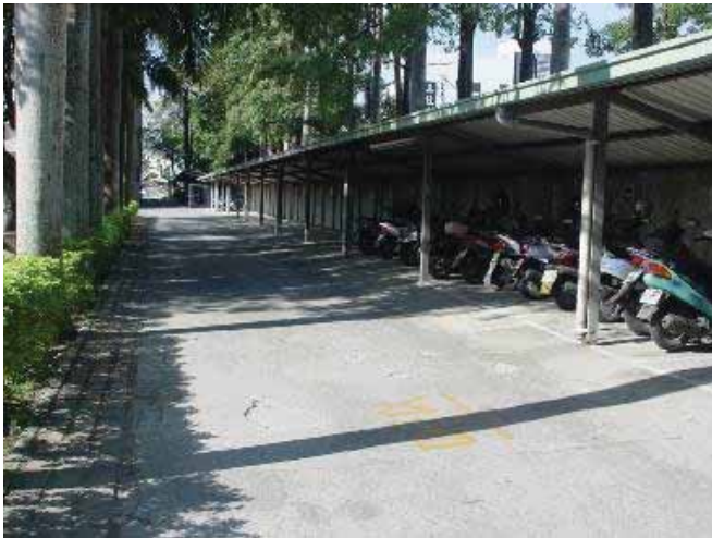
圖4.13 不透水的車道與停車場造成環境炙熱(改善前)
