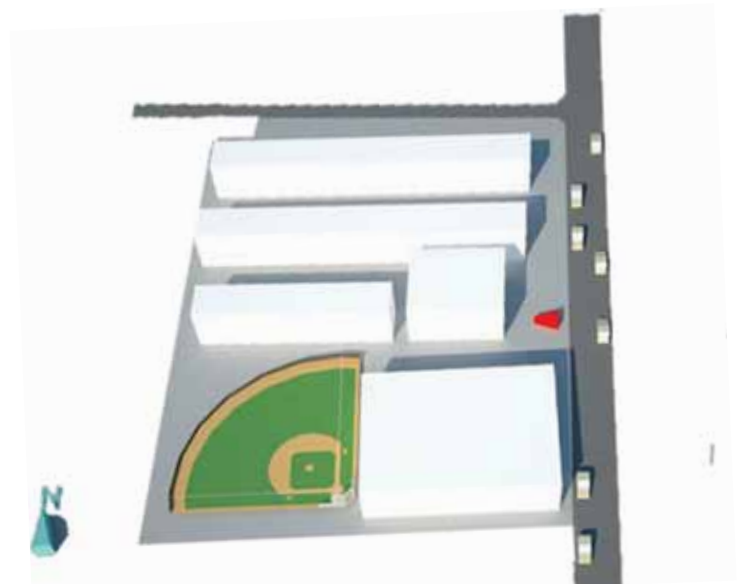
圖3.3 運動場改成小球場，變成南北通風採光之優良配置。
