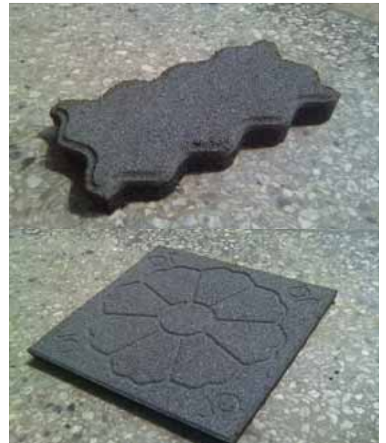
圖3.27 以廢輪胎再生的連鎖磚
