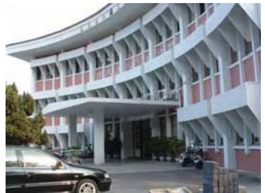
圖4.32 加裝美觀輕巧、富陰影韻律變化的金屬外遮陽設施(改善後)
