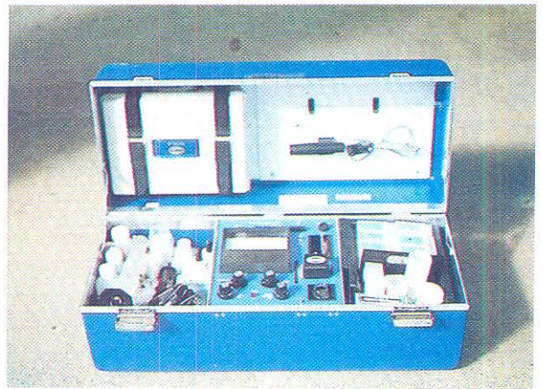
四、水質分析儀器 HACH DREL/5 meter
