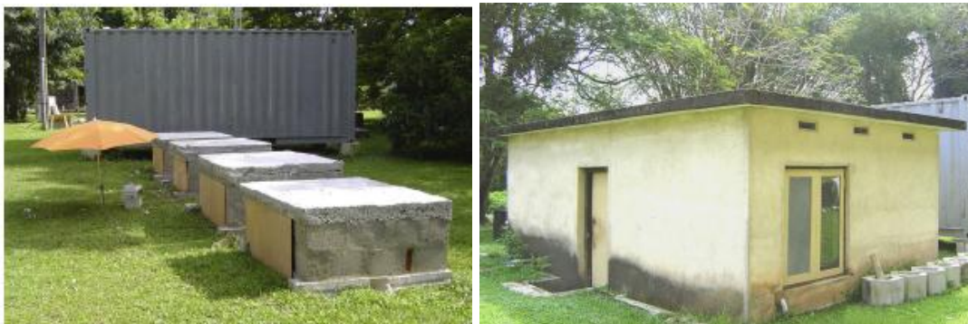
圖 1-20 一篇斯里蘭卡的研究以縮尺與全尺度實驗屋探討屋頂隔熱 (資料來源：Halwatura and Jayasinghe 2008)
