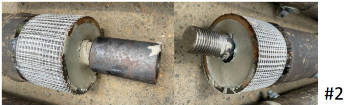
圖十.39 破壞方式：竹管與玻璃纖維完好，由施力/位移之實驗曲線推測為鋼筋降伏。
