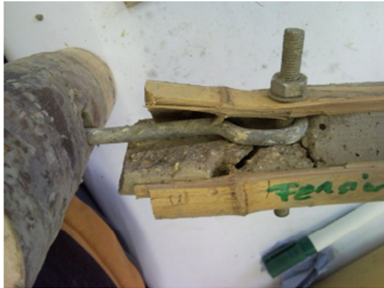
圖 7.6 填充混凝土之竹構接合[6]
