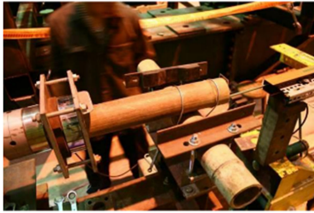
圖 7.18 結點滑移試驗裝置[4]
