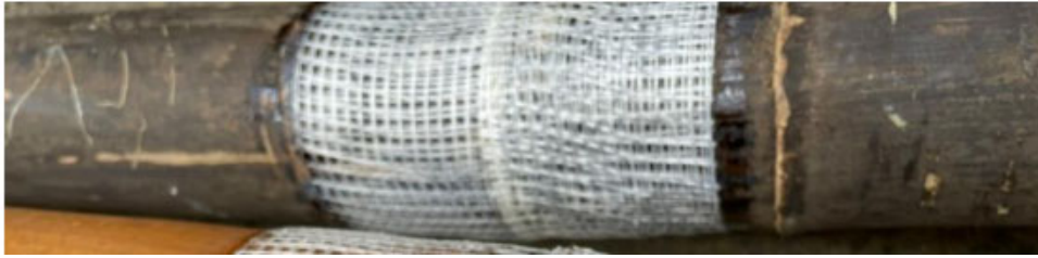
圖十.49 破壞方式: 竹管與玻璃纖維完好，由施力/位移之實驗曲線推測為鋼筋降伏。
