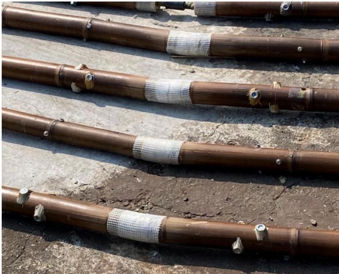
圖十一.56 破壞方式：根據試體外觀與荷載曲線判斷破壞為鋼筋降伏
