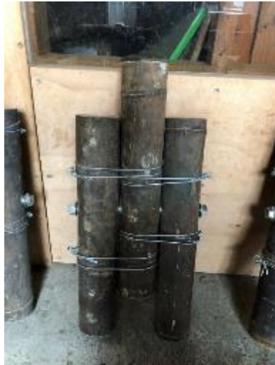
圖 7.23 大藏竹管續接抗剪試驗[18](使用螺栓及綁紮接合)
