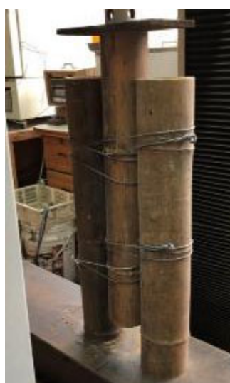
圖 7.21 大藏竹管續接抗剪試驗[17](僅使用綁紮接合)
