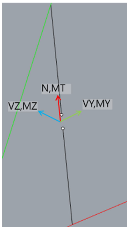
圖 7.16 可從計算模型中讀取彈簧位移與內力
