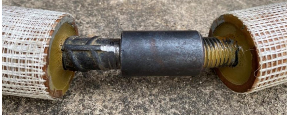
圖十一.49 破壞方式：根據試體外觀與荷載曲線判斷破壞為鋼筋降伏
