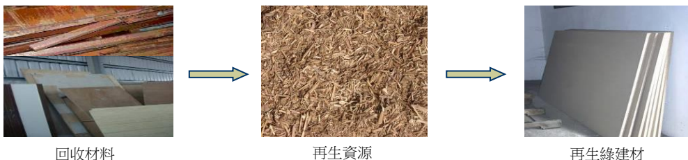
圖 6-2 木質材料回收製造再生綠建材流程
