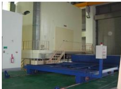
(a) 樓板衝擊音基準樓板裝置
