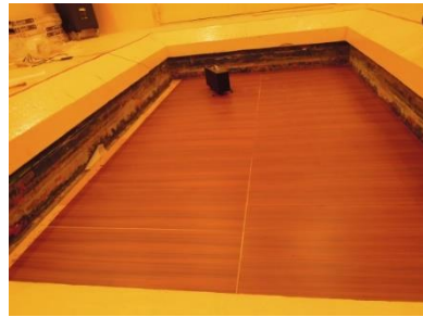
(b) 輕量衝擊源樓板衝擊音測試
