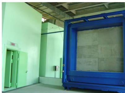
(a) 牆板隔音測試設施
