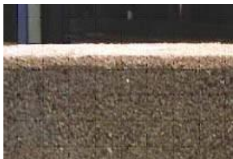
圖 7-22 透水性樹脂混合粒料之構造
