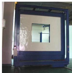
(b) 窗戶隔音測試設施
