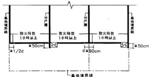
建築物側面外牆（或分戶牆）突出正面/背面外牆 50cm 以上，或分戶牆與正面/背面之外牆交接處 d 達 90cm 以上，或正面/背面之外牆至距離側面外牆 1/2d 以上始設開口者，開設於正面/背面外牆之門窗防火性能得不受與側面境界線距離之限制。
