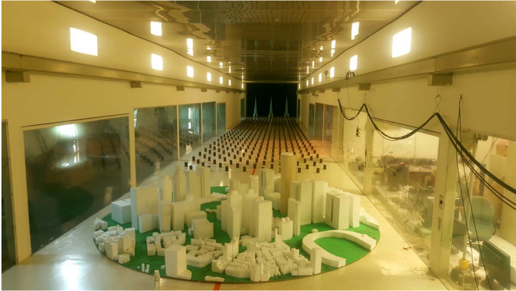
圖 3-10 風洞試驗配置
