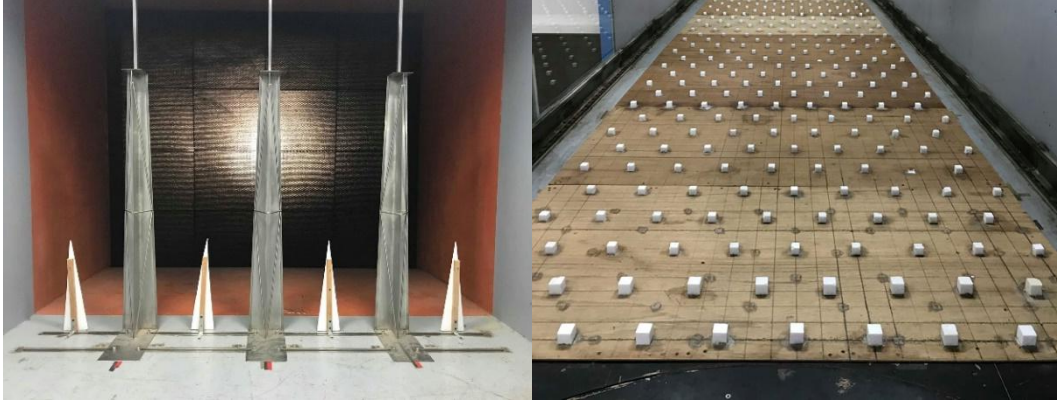
圖 3-9 淡江大學風工程研究中心粗糙元及三角錐形渦流產生器
