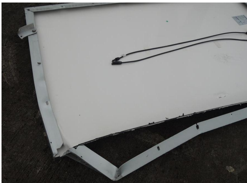
圖 2-7 面板框架處之破壞
