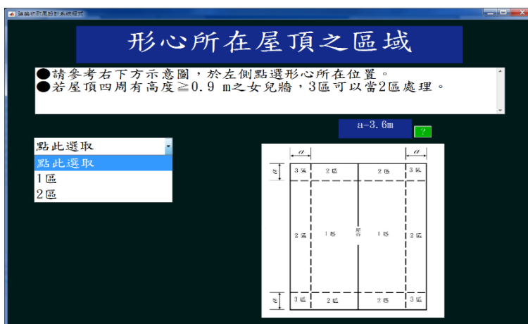
圖 7-25 「所在之屋頂區域」頁面( h \leq 18m , 平屋頂且女兒牆高度 \geq 0.9m )
