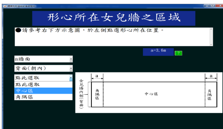
圖 7-14 「形心所在之女兒牆區域」頁面(構件朝內, h \leq 18\text{m} ,女兒牆高度小於 0.9\text{m} )
