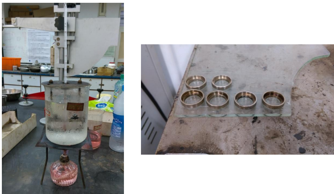
圖 4-11 瀝青軟化點試驗器材（環球法）
