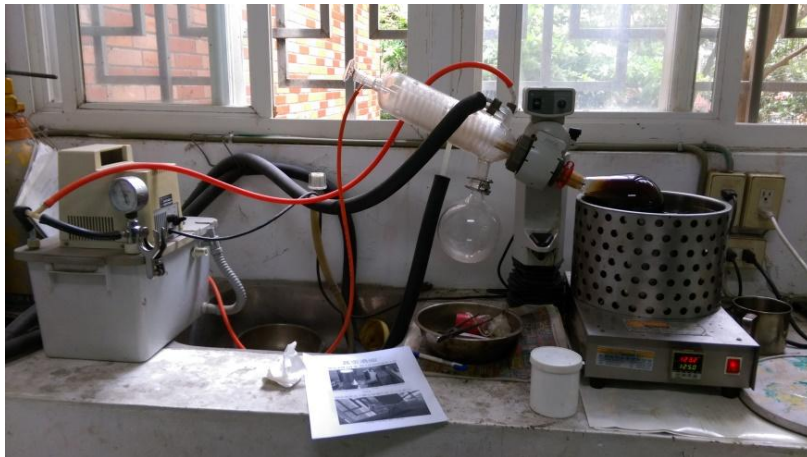
圖 4-9 分離甲苯瀝青溶液用真空濃縮機
