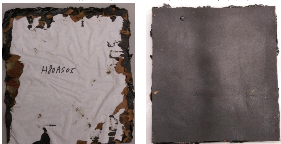
圖 4-24 瀝青防水層試體以 80°C 曝曬 500 小時後外觀
