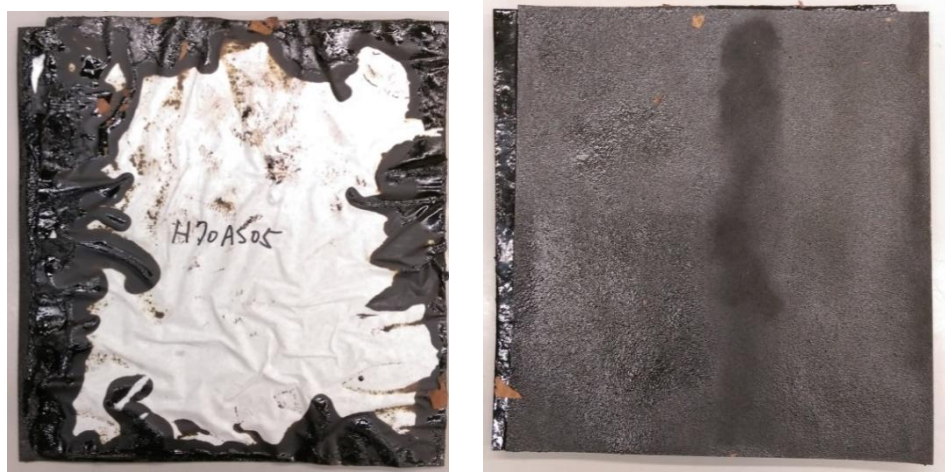
圖 4-23 瀝青防水層試體以 70°C 曝曬 500 小時後外觀
