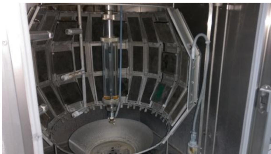
圖 4-7 試片安裝於氙弧燈耐候試驗機內部情形
