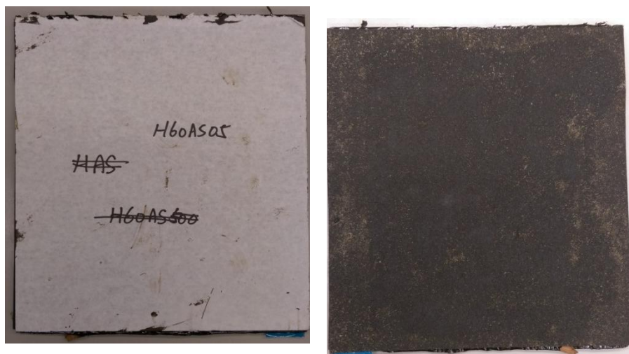
圖 4-22 瀝青防水層試體以 60°C 曝曬 500 小時後外觀
