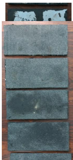
圖 4-17 氙弧燈曝曬瀝青防水層試體 15×7(cm)
