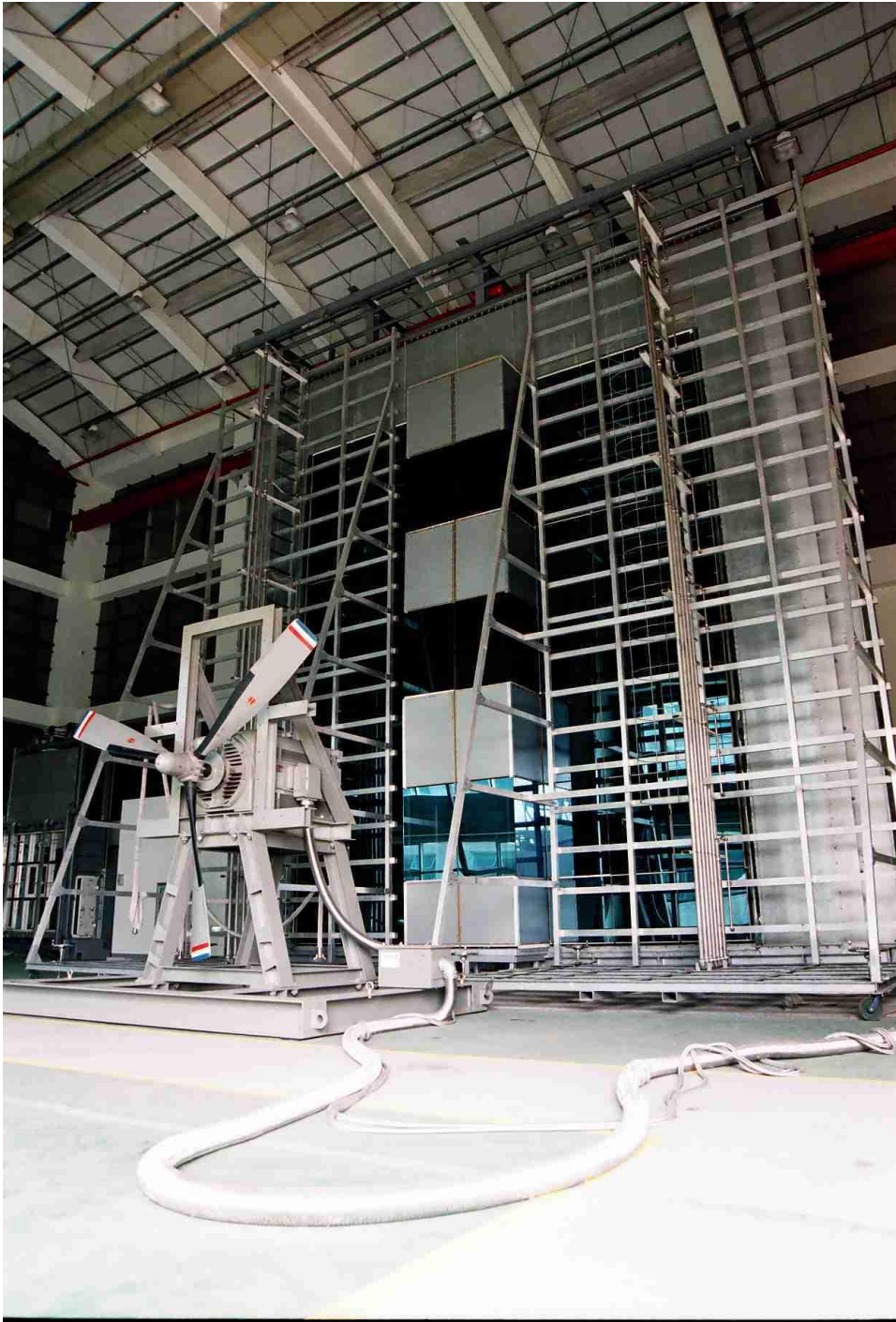
圖2-2 帷幕牆風雨試驗
