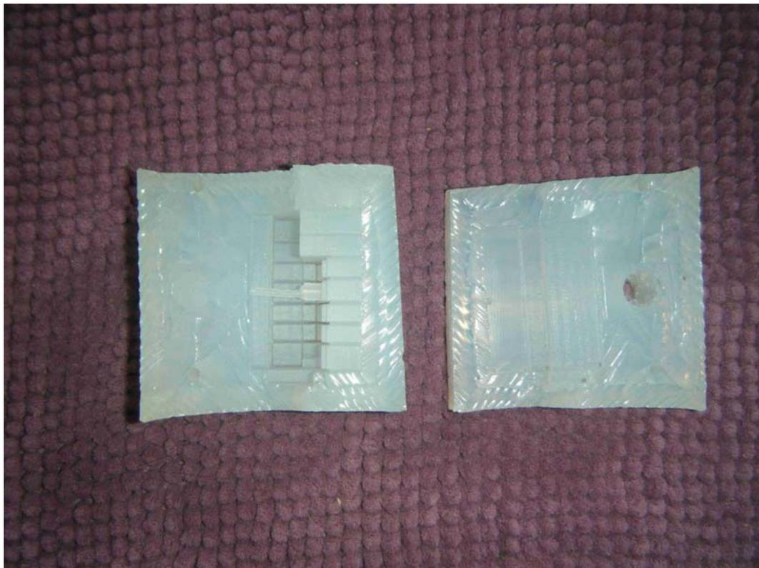
圖4-14 以 silicone 開模灌注製作下阻水塊
