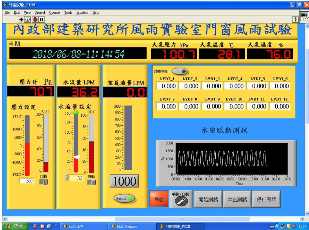
圖4-9 水密性試驗之 LabVIEW 儀控軟體
