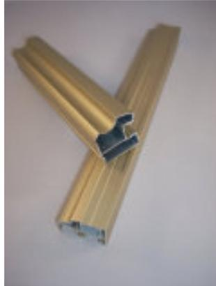
圖2-2 以鋁合金製成之鋁擠型
