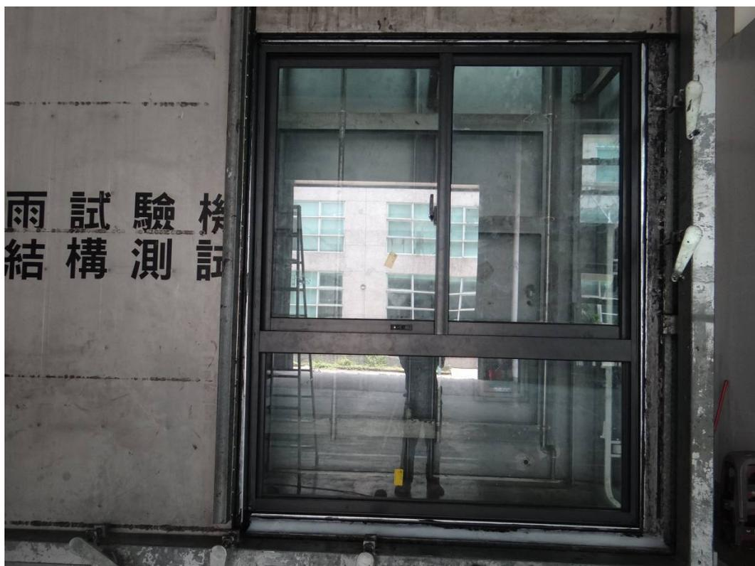
圖4-35 試體編號：T4（「橫拉+固定」窗）
