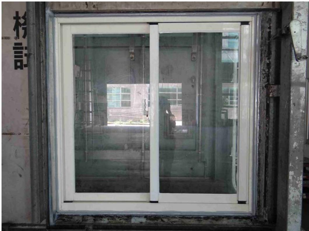
圖4-19 橫拉窗試體安裝至測試艙
