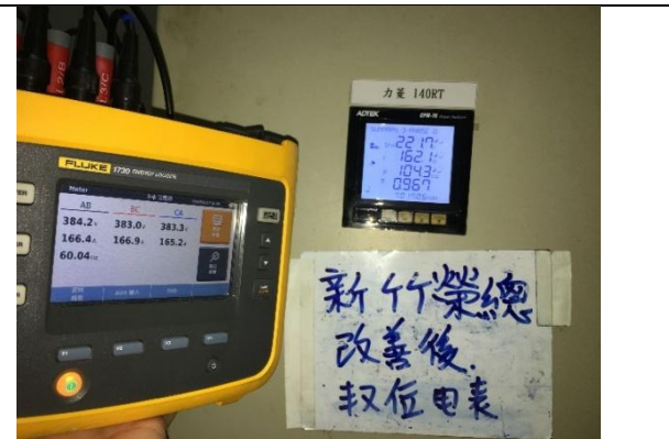
項目：改善後 冰水主機消耗電力量測
