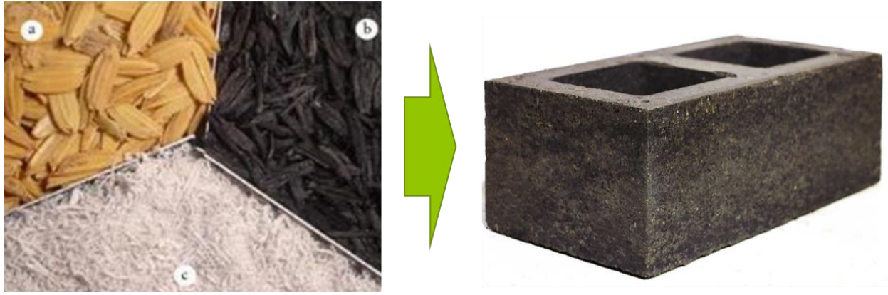
圖 5-7、以稻殼灰渣製作成耐火磚之示意圖
