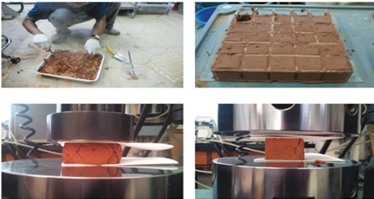
圖 5-19、微生物聚合物混合土塊製作與抗壓強度測試之示意圖
