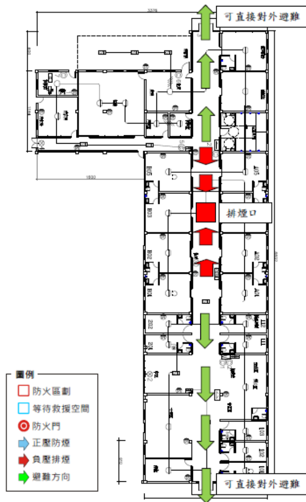
圖 2-5 某老人長照中心(中央核心型)排煙設計建議示意圖
