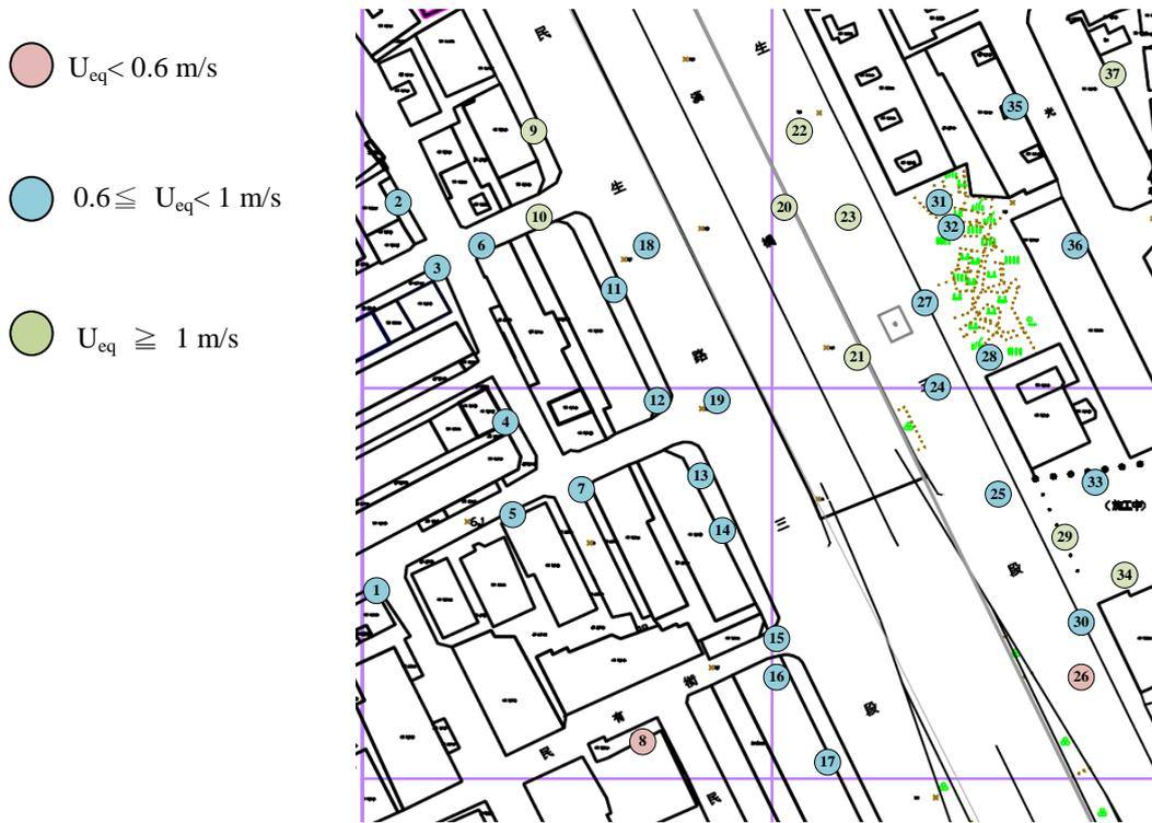
圖 4-13 研究區風洞試驗等效風速分布圖
