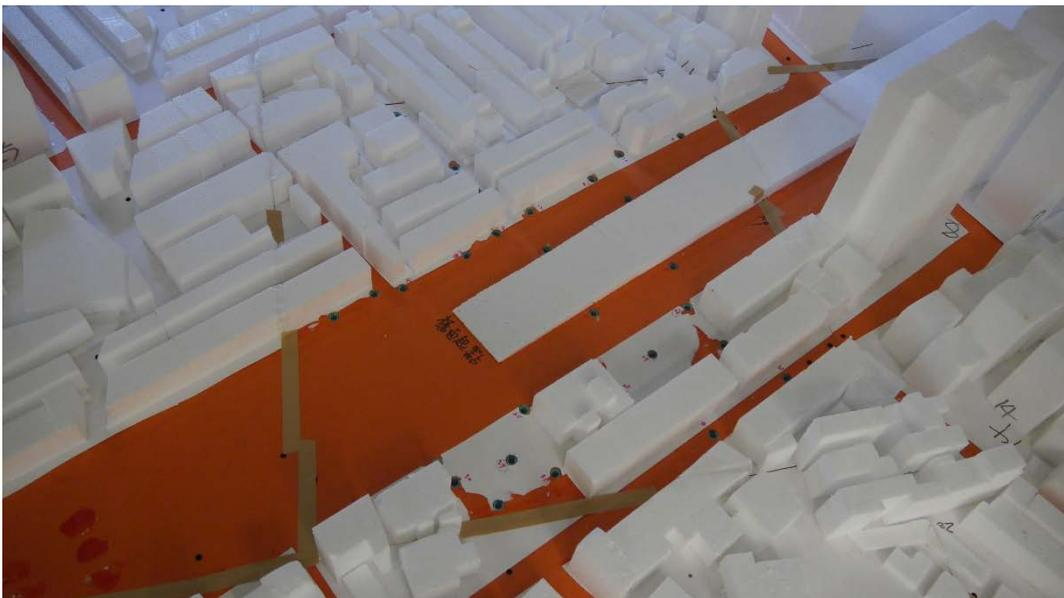
圖 3-13 地表風速計埋設
