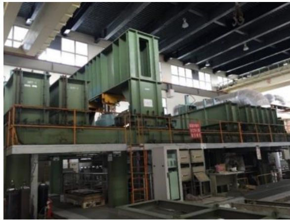
圖 3-12 防火實驗中心之複合實驗爐
