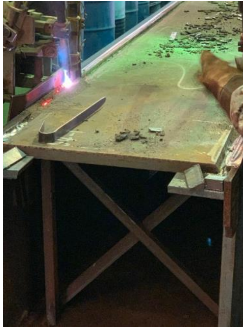
圖 3-8 潛弧銲接 SAW 銲接施作圖
