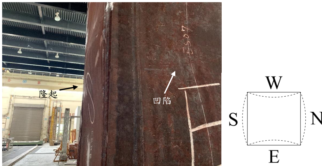
圖 4-35 試體 B6T7-19 實驗後局部挫屈外觀
