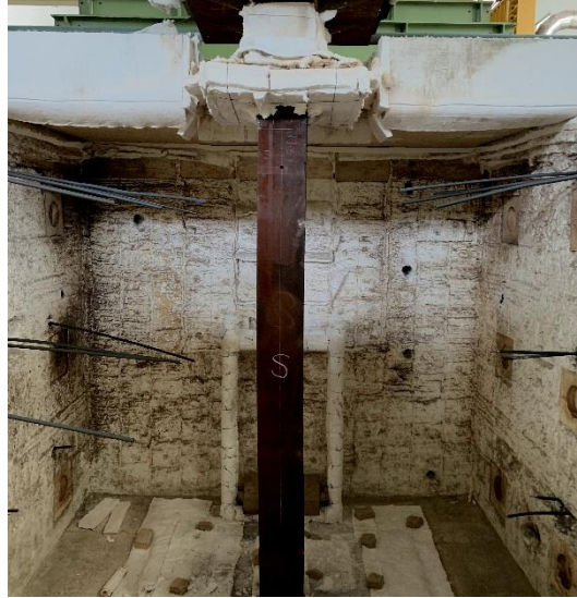
圖 4-6 試體 B3T6-39 實驗後外觀
