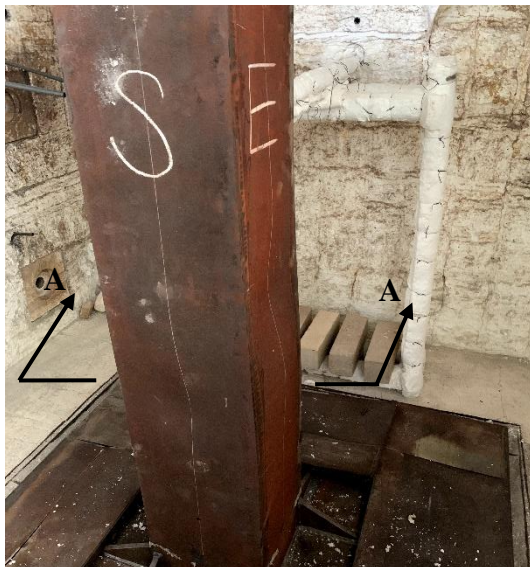
圖 4-25 試體 B5T6-23 實驗後局部挫屈外觀
