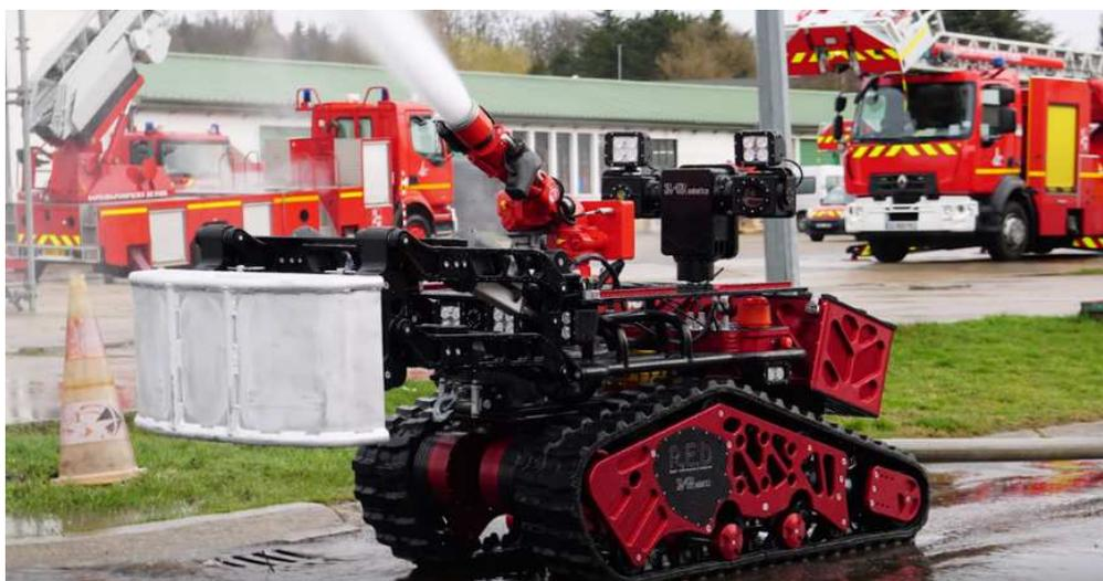
圖 4- 5 The Fire Fighting robot COLOSSUS
