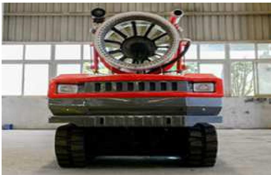
圖 2-14 滅火、排煙消防機器人
