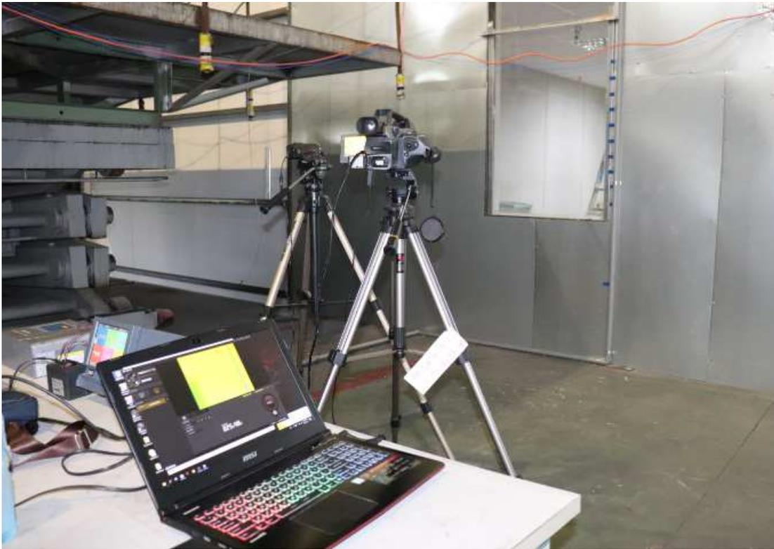
圖 3- 32 熱顯像儀架設
