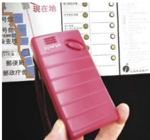
圖 2-30 話音資訊系統利用電子指示牌傳送訊號至手提終端機
