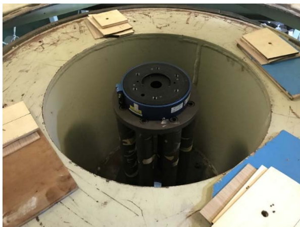
圖 3-6 六力平衡儀安裝於風洞之轉盤基座圖 資料來源：本計畫實驗拍攝
