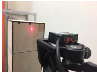
(c)雷射位移計頂層架設 (d)雷射位移計底層架設
