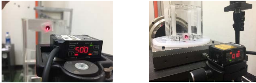
(c)雷射位移計頂層架設 (d) 雷射位移計底層架設
