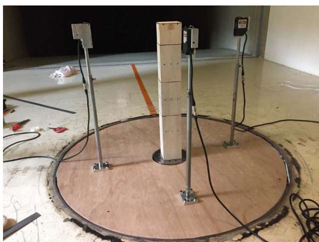
圖 3-12 雷射位移計量測模型頂端位移圖 資料來源：本計畫實驗拍攝
