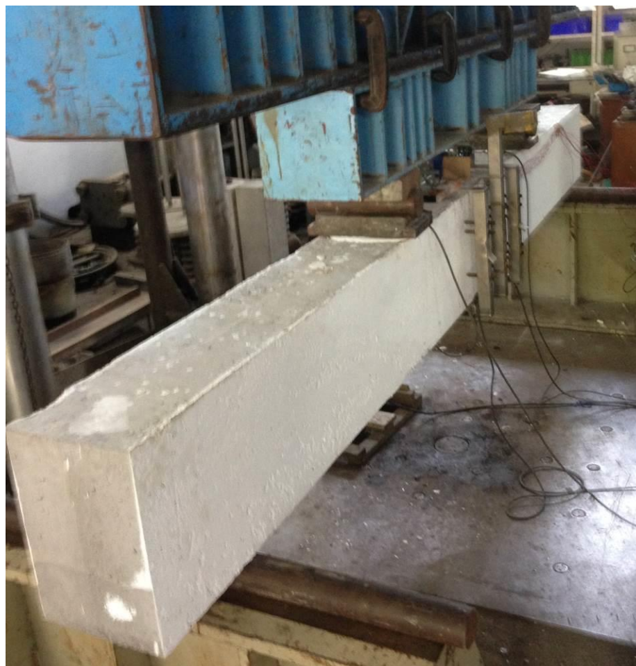
圖 3-32 架設完成的梁試體 (資料來源：本研究整理)
