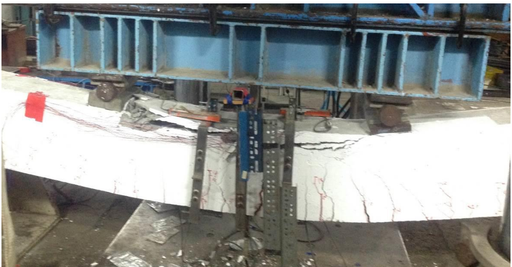
圖 4-21 蒸氣養護梁試體破壞情形(56 天) (資料來源：本研究整理)
