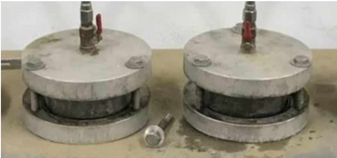
圖 3-31 混凝土滲透試驗 (資料來源：本研究整理)
