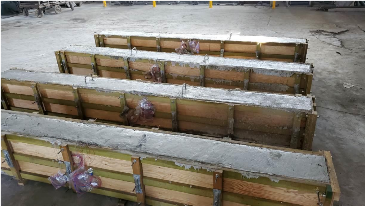
圖 3-15 室內常溫養護之梁試體（資料來源：本研究整理）
