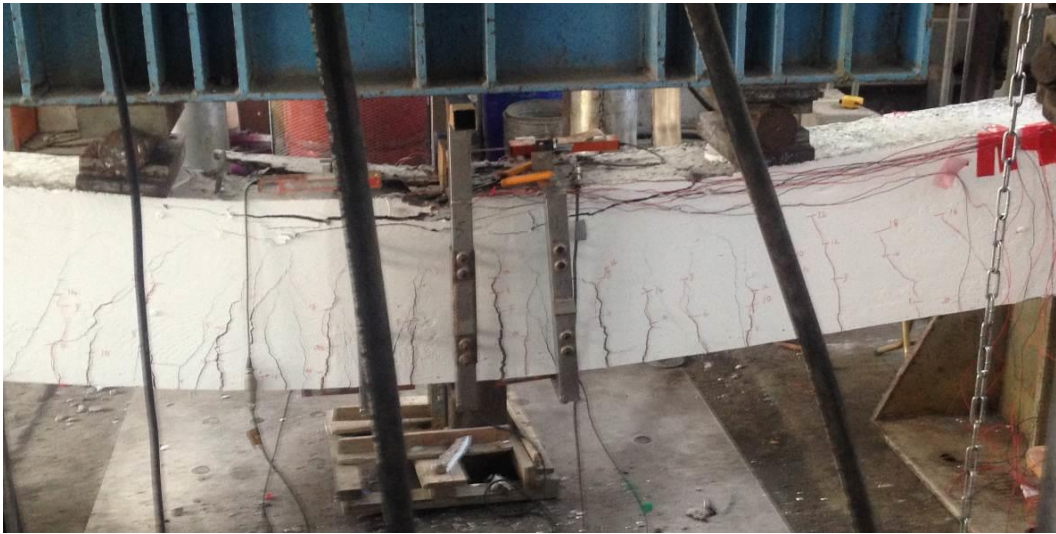
圖 4-20 常溫養護梁試體破壞情形(56 天) (資料來源：本研究整理)
