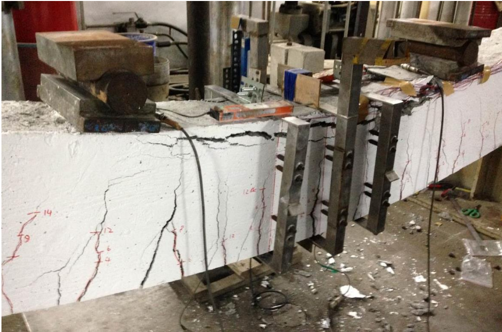
圖 4-18 常溫養護梁試體破壞情形(28 天) (資料來源：本研究整理)
