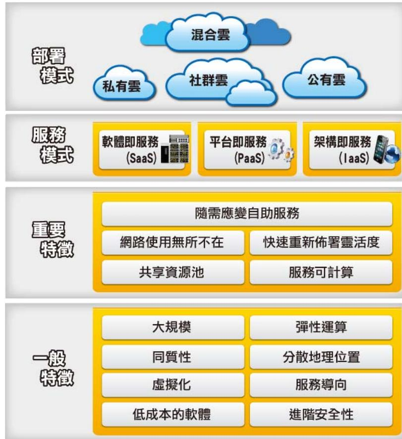
圖 2-5 雲端運算整體架構
